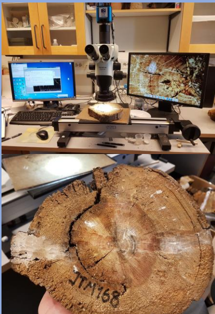
Figur 2: Standardutrustning för trädriingsanalys som användes under projektet, bestående av bland annat stereomikroskop, ett LINTAB-mätbord kopplat till en dator med programmet TSAP-win. Den undre bilden visar ett subfossilt trädprov med tre utskurna radier.
