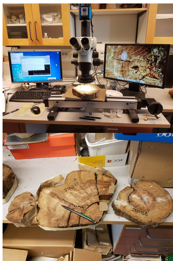
Figur 2: Bilder på provutrustning och prover som användes vid mätningarna. Den övre bilden visar standarddendrokronologisk mätutrustning med bland annat LINTAB bord och stereomikroskop. Den undre visar tre trädprover med utskurna radier.
