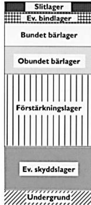
Figur 3: Väggroppens uppbyggnad (Asfaltboken, 2021)
