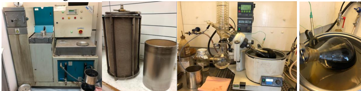
Figur 23: De två vänstra bilderna visar asfaltanalysatorn och tillhörande cylindrar och de två högra bilderna visar rotationsindunstaren.
