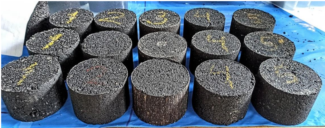
Figur 37: 15 av de 20 framställda provkropparna, Från vänster till höger visas återvinningshalterna 0, 40, 60, 80 och 100%.
