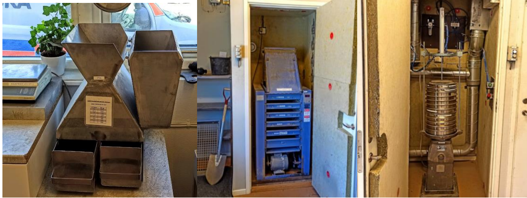
Figur 22: Från vänster en apparat för att fördela ner proverna till hanterbara mängder, grovsikt och längst till höger en finsikt.
