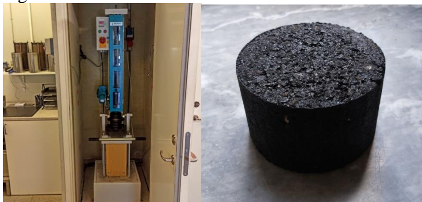
Figur 27: Till vänster pågående marshallinstampning, till höger den färdiga marshallprovkroppen.
