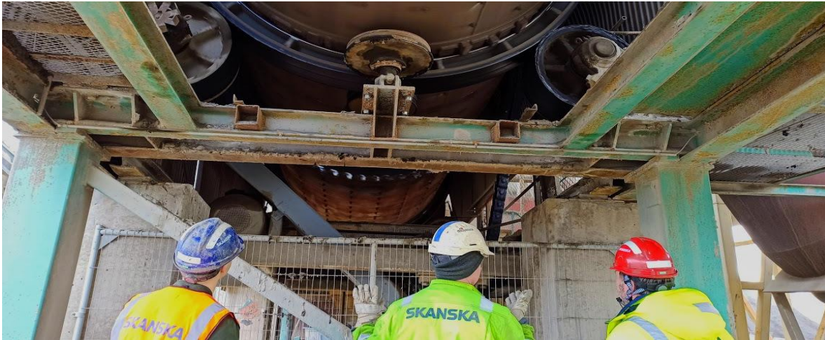
Figur 8: Torktrummans underrede på asfaltverket i Dalby, där dess kuggkrans och drivkedja kan skymtas.
