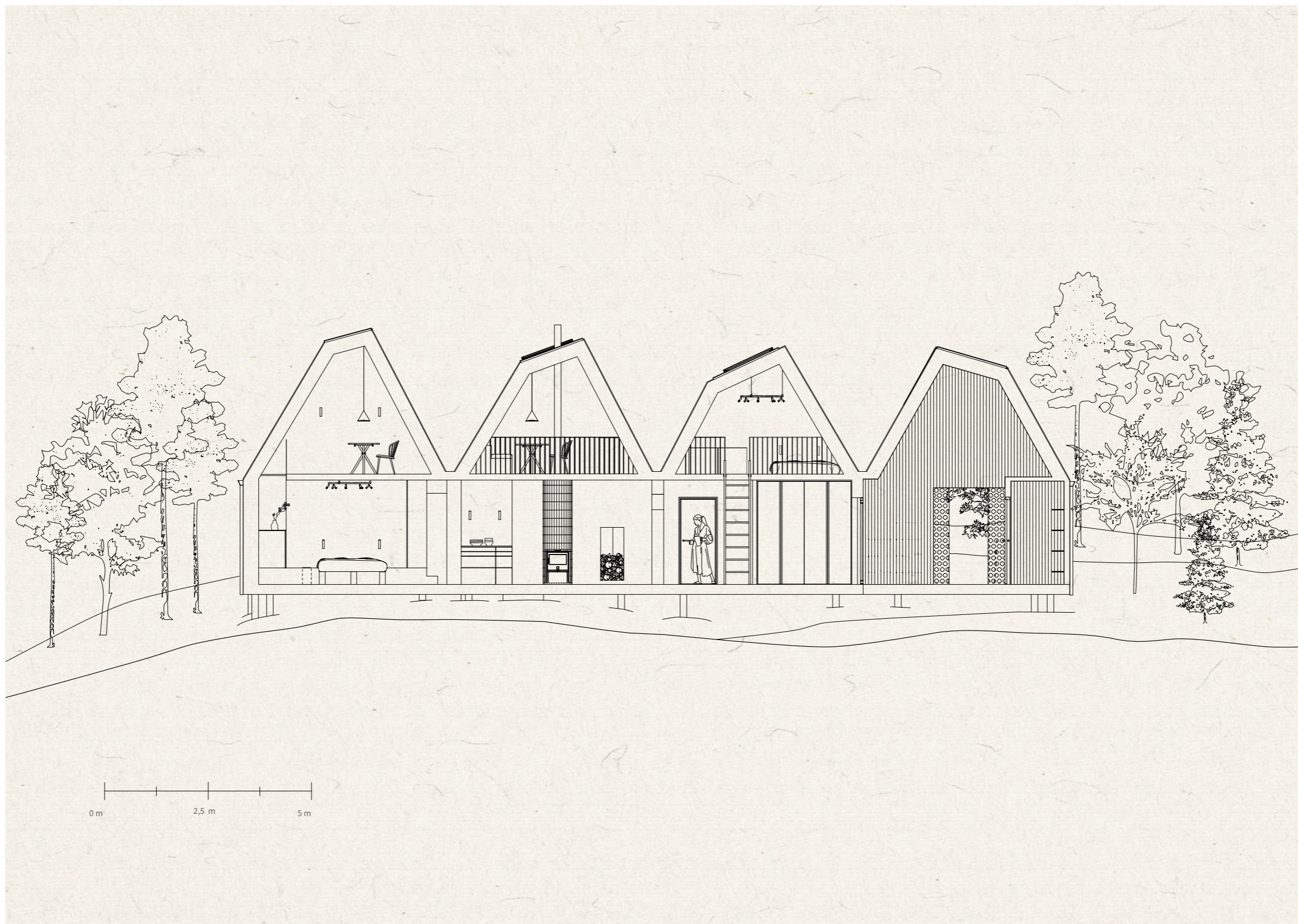
↑ Sektion åt motsatt håll visar vedkaminen och den öppna vedförvaringen som ger sikt mellan rummen men även ved åt gjutjärnsspisen. I hallen finns en stega som leder upp till ett loft med säng och förvaring. I sovrummet placerat på plan ett finns det förvaring under det upphöjda golvet.
