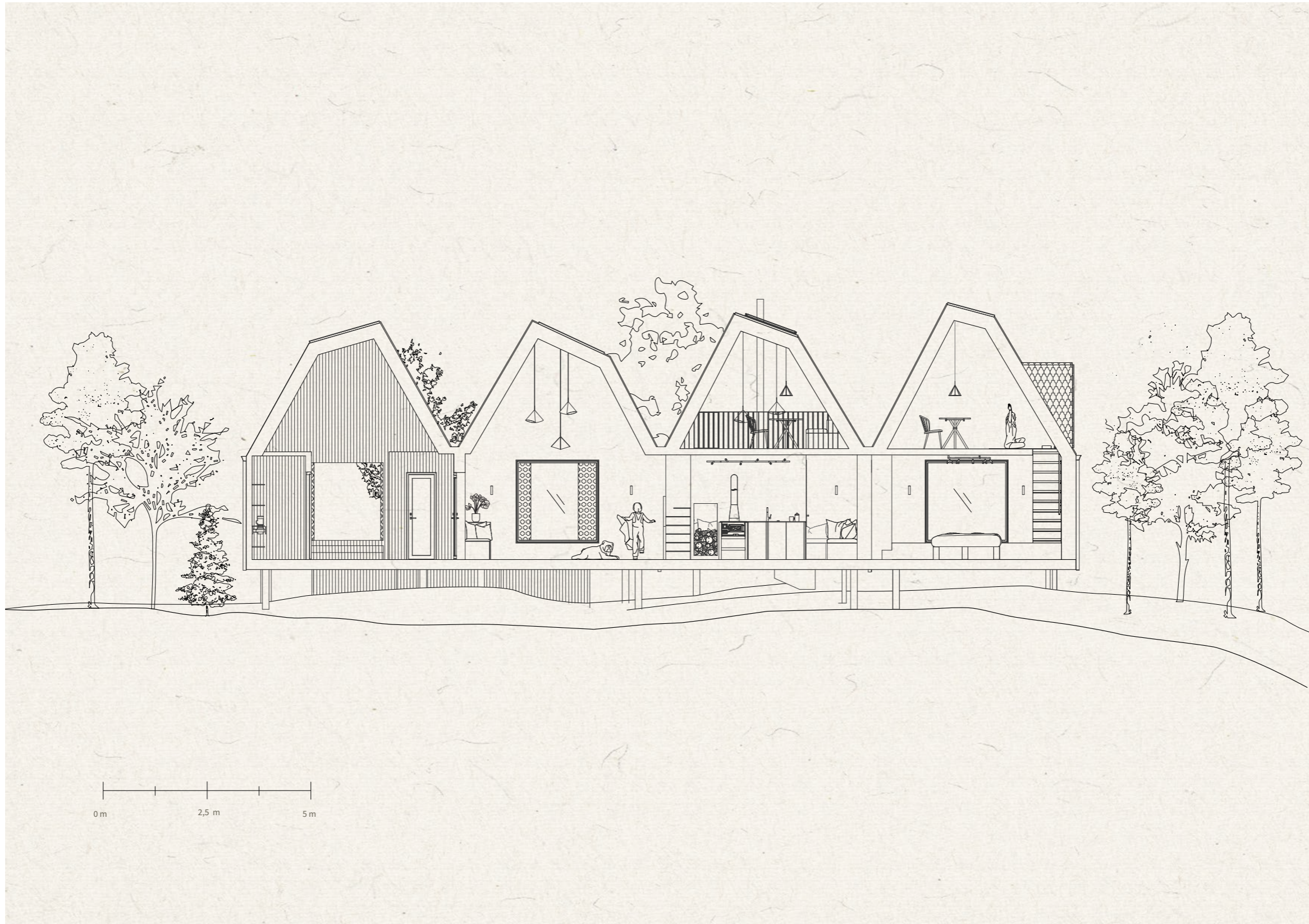
↑ Sektionen visar nivåerna i rummet. De varierande takhöjderna och topografin. Loftet som ger möjlighet att nyttja modulernas rymd. De stora fönstren släpper in naturen till rumsligheterna innanför väggarna.
