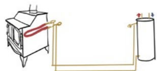
↑ Enkel skiss av värmesystem för varmvatten och golvvärme.
