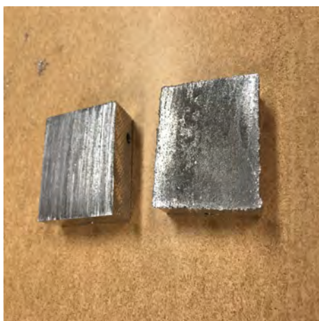
Figur 37: Visar bild på undersida av släpkontakt i aluminium efter körda tester. Till vänster kontakt som leder ström upp ur bana och till höger kontakt som leder ström ner i bana.
