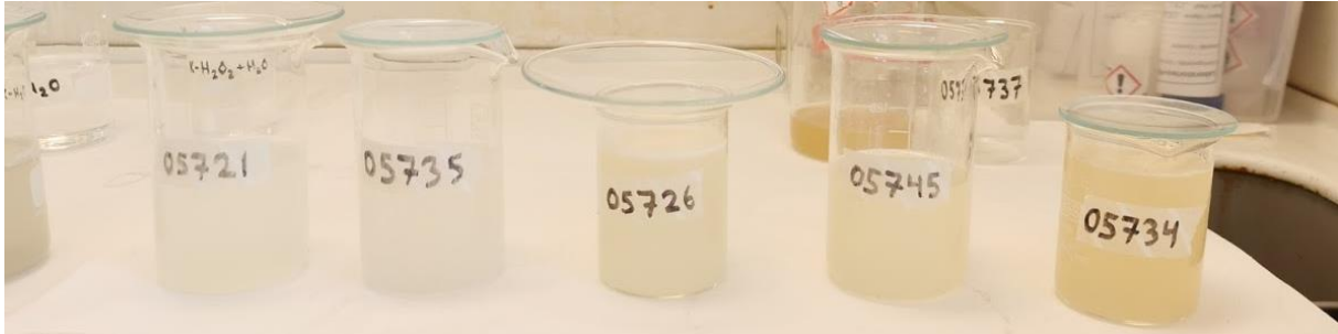
Figur 11. Bägare med 25 ml väteperoxid tillsatt i de resterande proverna.
