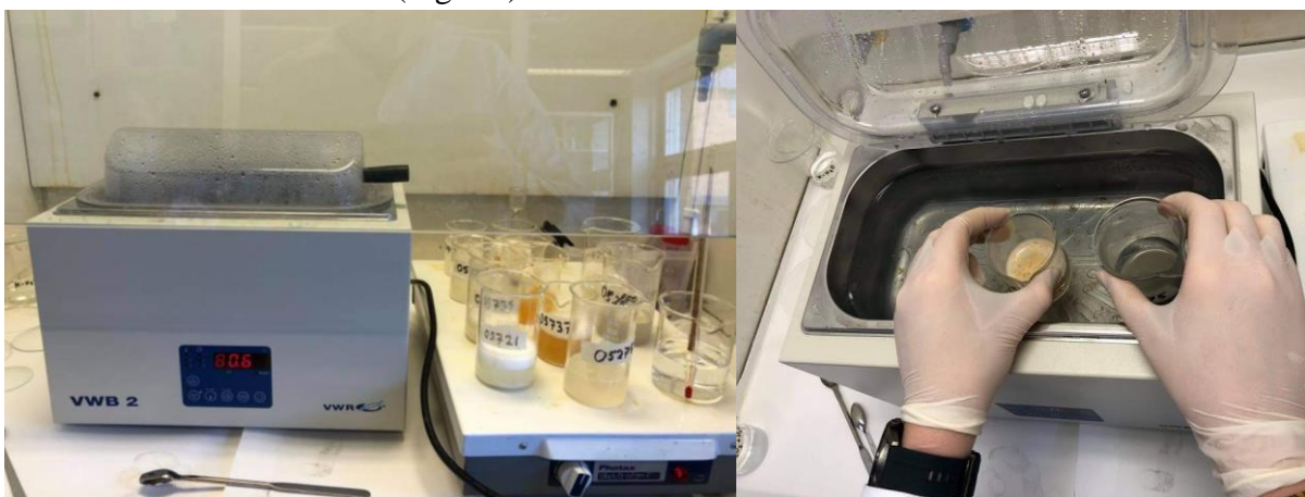
Figur 7. Vattenbaduppställningen och proverna nedsänkta i vattenbadet.
