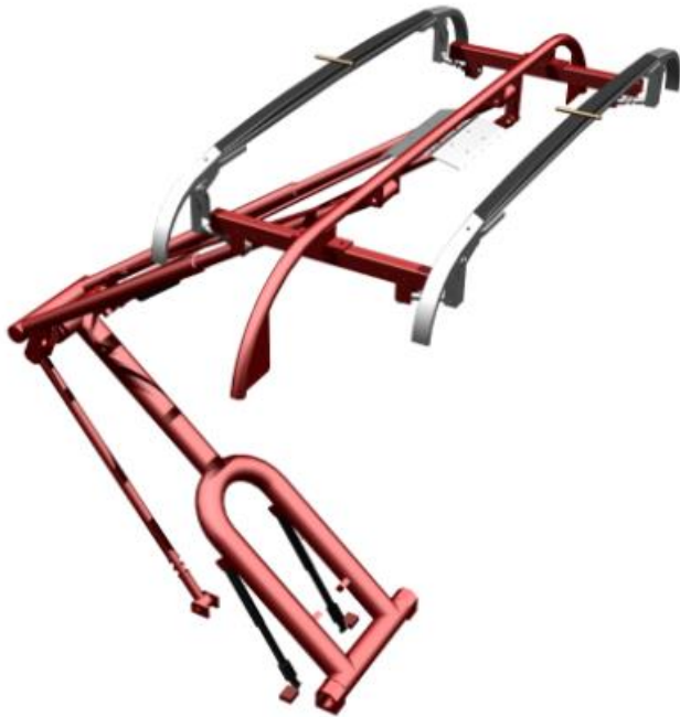
Figur 16: Exempel på strömavtagare. (Banverket 2006)
