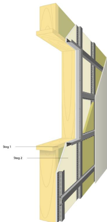
Figur 25. Illustration av en typisk ytterväggskonstruktion (Europrofil, u.å.).
