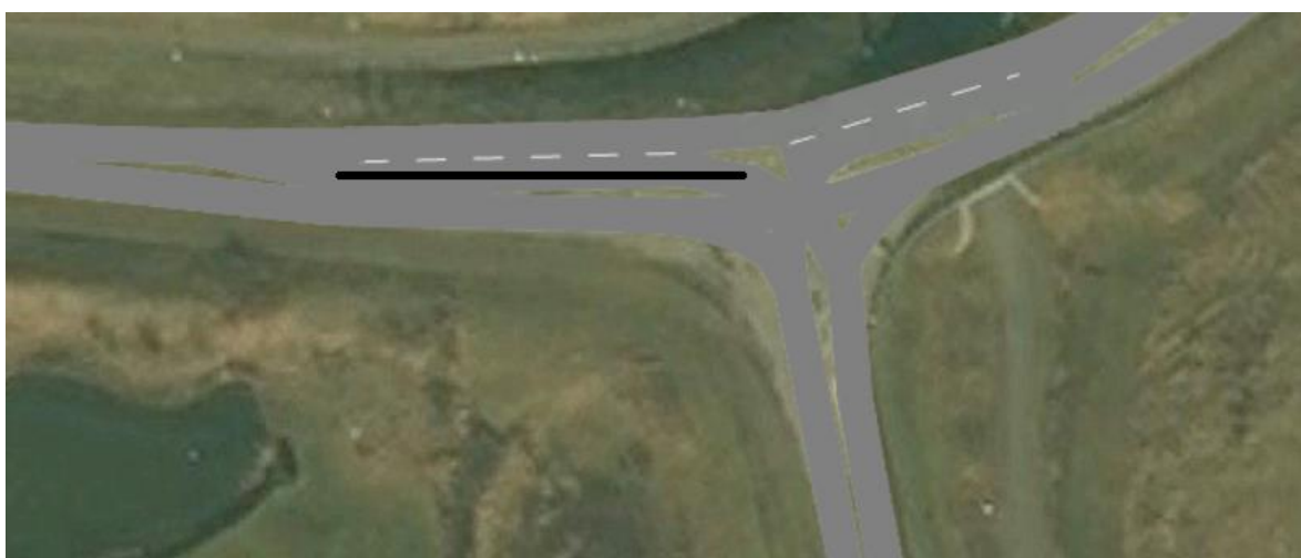
Figur 10: Den svarta linjen förtydligar var det extra körfältet finns placerad (PTV Vissim, 2021).
