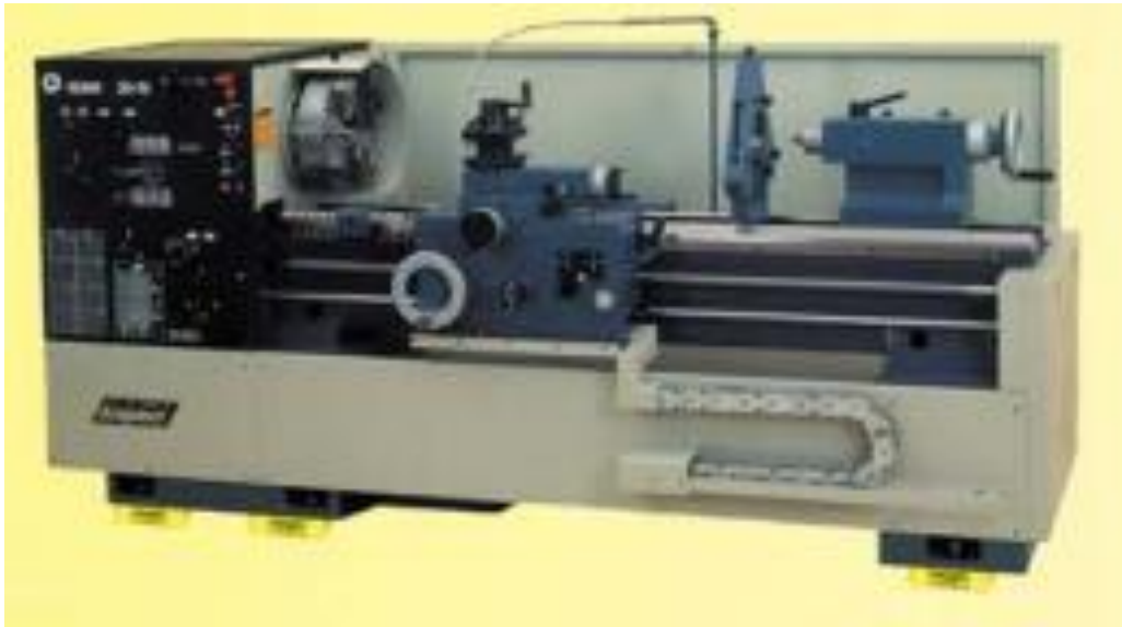
Figur 44 Unisorb i botten av en maskin för att justera infästning.
