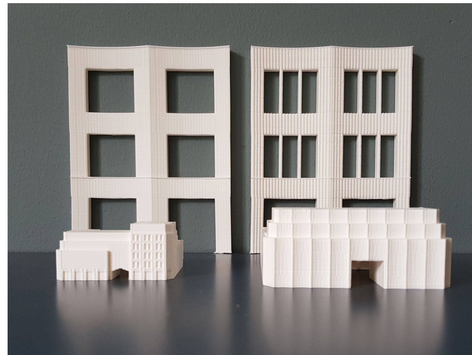
De volymstudier med mest potential valdes att 3D printas för att betraktas i verkligt ljus från flera vinklar. Inzoomningar av fasadelement i bakgrunden. Till höger syns vad som hade varit keramiska kassetter som ger ett finare lager av vertikalitet.
