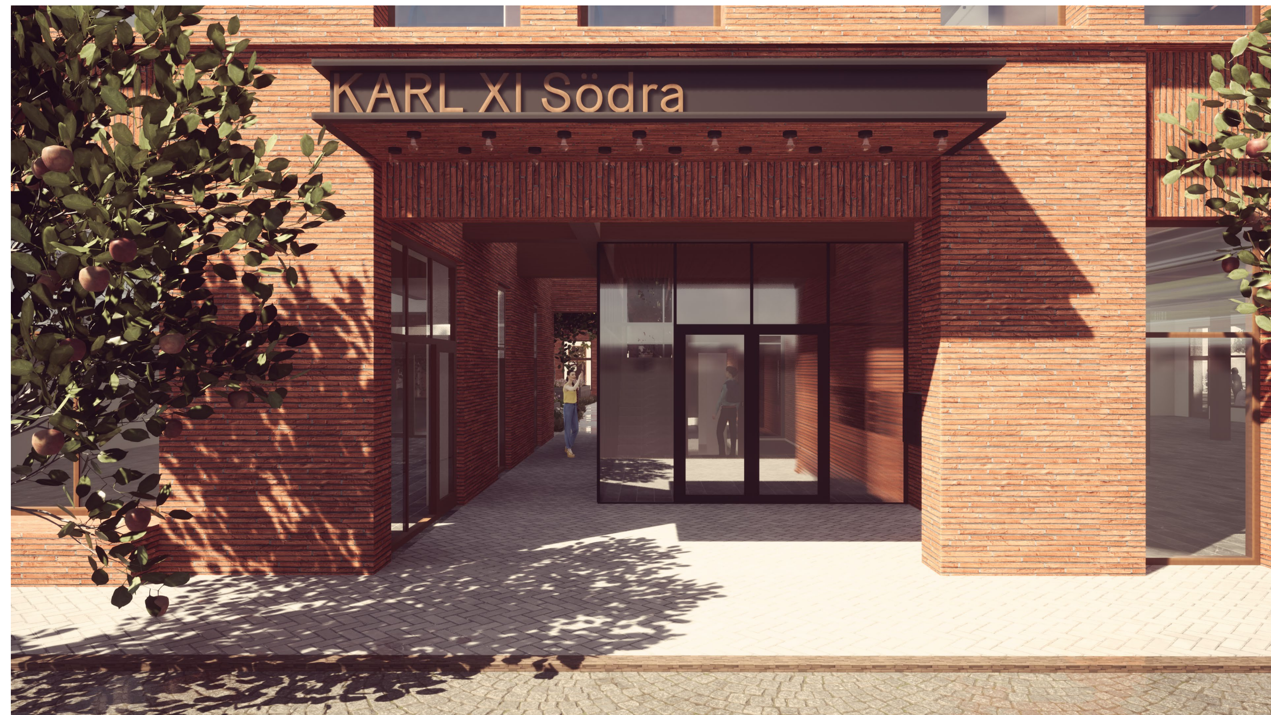
Den södra huvudentrén. Rummet fungerar som ett slags mellanrum, en inplacerad glasbox för klimatskydd och transparens. Kontakten med smitvägen mot innergården var viktig att bibehålla för trygghet.
