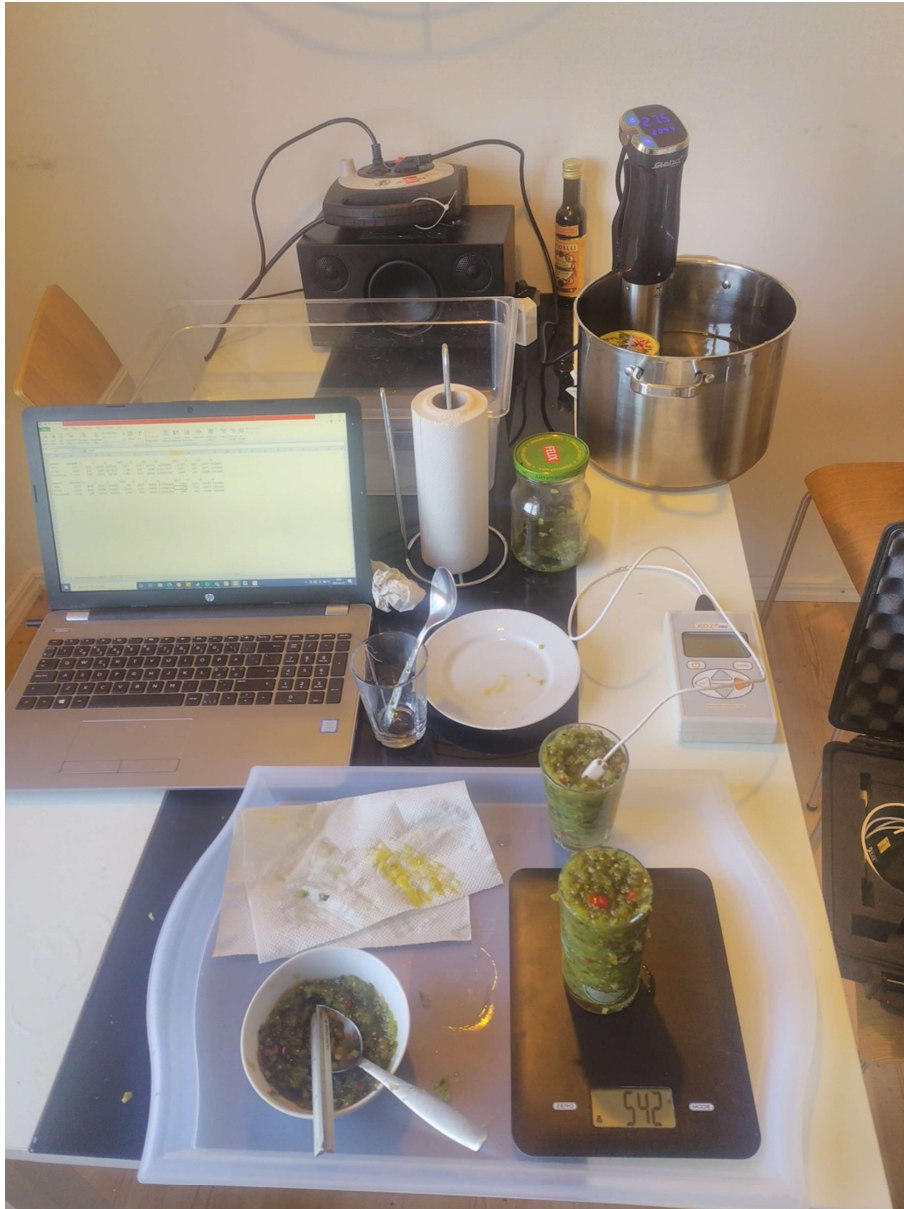
Figur 6. Visar labbuppsättningen för mätning av densitet och värmeledningstal på gurkmix.
