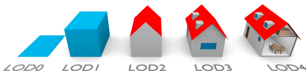
Figur 3.2. De fem olika LOD-nivåerna i CityGML 2.0. Bilden är från Biljecki et al. (2016). © 2016 Filip Biljecki, Hugo Ledoux och Jantier Stoter. Använd med tillstånd från författarna.
