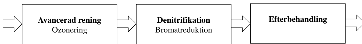
Figur 2.3. Bromatreducering genom denitrifikation, position i reningsprocessen. Fortsättning på figur 2.1.
