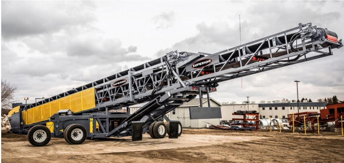
Figur 6-2. Ett indexerat transportband (Superior, 2021) Copyright (2021) med tillstånd från Superior Industries, Inc.
