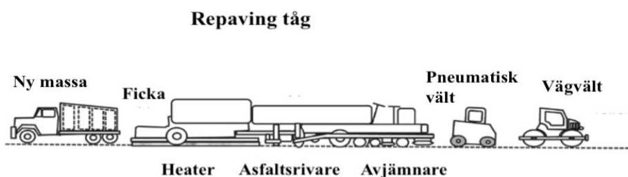
Figur 3-14. Schematisk skiss av ett så kallat Repaving återvinningståg (Kandhal & Mallick, 1997). Översatt från engelska.
