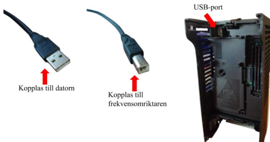
Figur 15: Hur PowerFlex 525 kopplas till datorn
