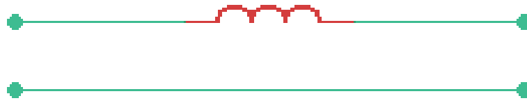
Figur 2.3: Variabel likströmsmellanled med en spole
