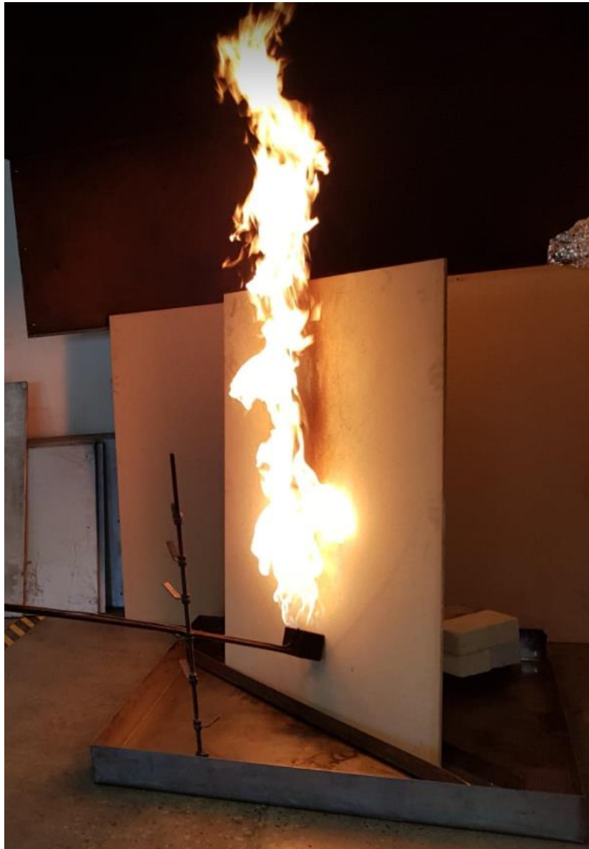
Figur B1. Påbörjad antändning m.h.a. gaslåga.
