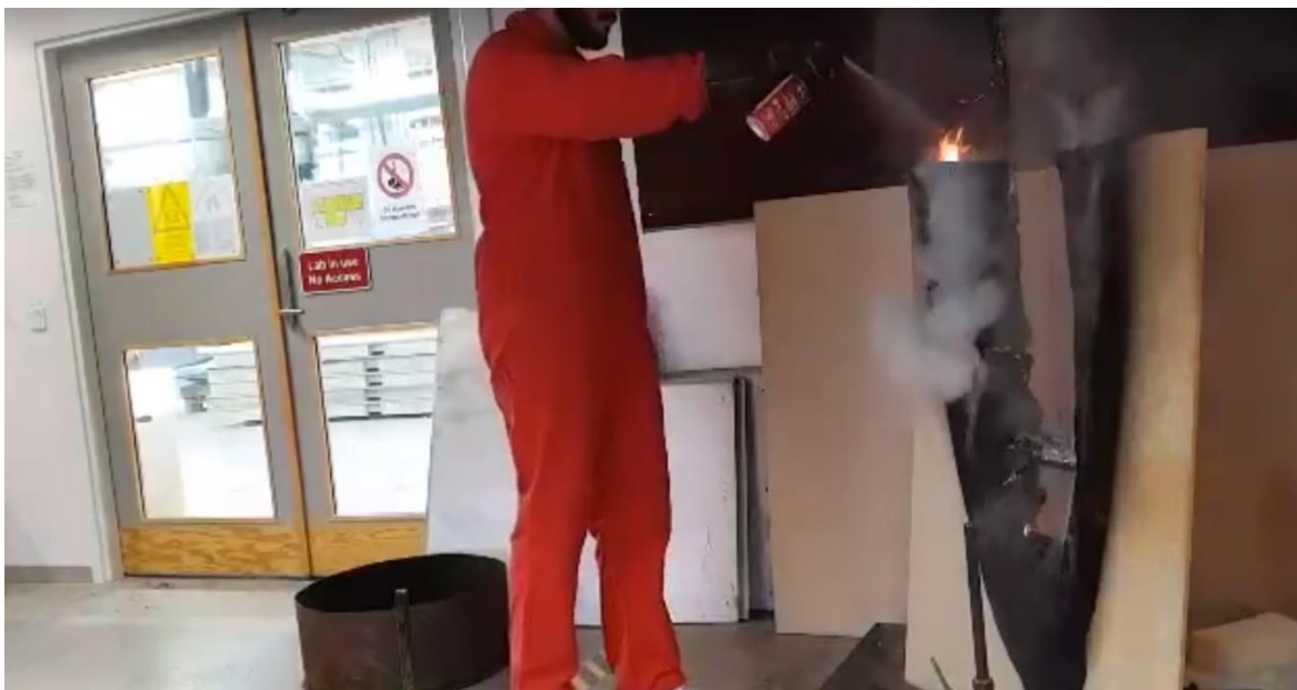
Figur B5. Närmande till följd av ofullständig släckning (släckförsök 2).
