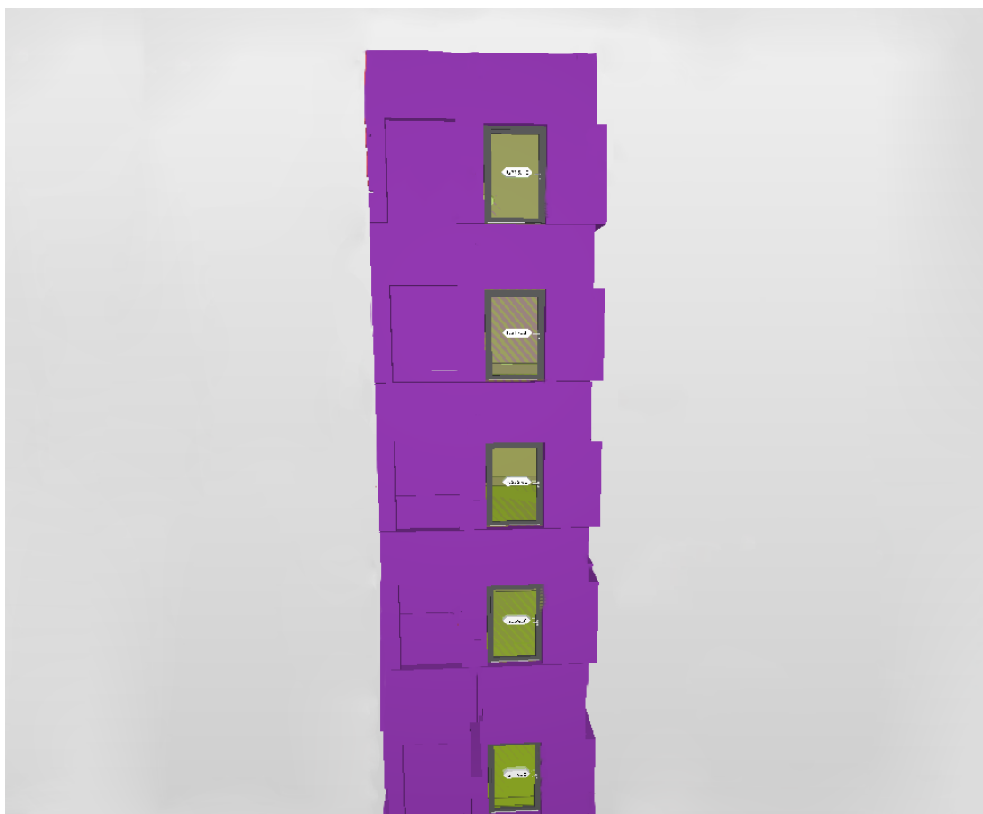
Figur 24: En del av ett trapphus som utgör utrymningsväg. Dörrar är markerade med brandskyddsobjekt avseende brandteknisk klass. Bilden är tagen i Solibri Office.
