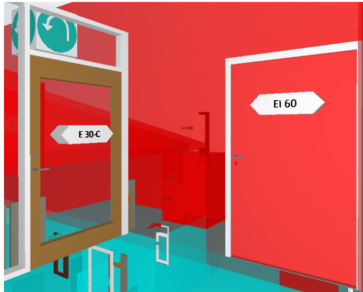
Figur 20: Brandklassade dörrar i brandcellsgränser varav den vänstra har krav på dörrstängare och återinrymning.
