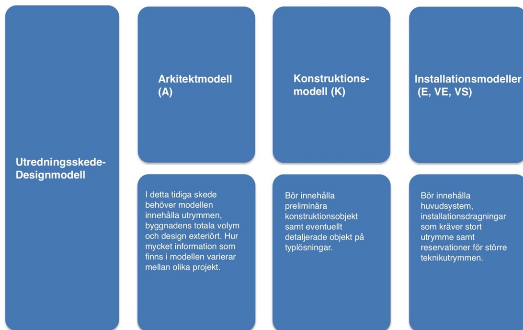
Figur 2. Illustrerar informationsmängden i utredningsskedet för de olika disciplinernas modeller, bilden är inspirerad av Nolliplan AB (Kristiansson, BIM-dokument för svenska byggprojekt, 2018).
