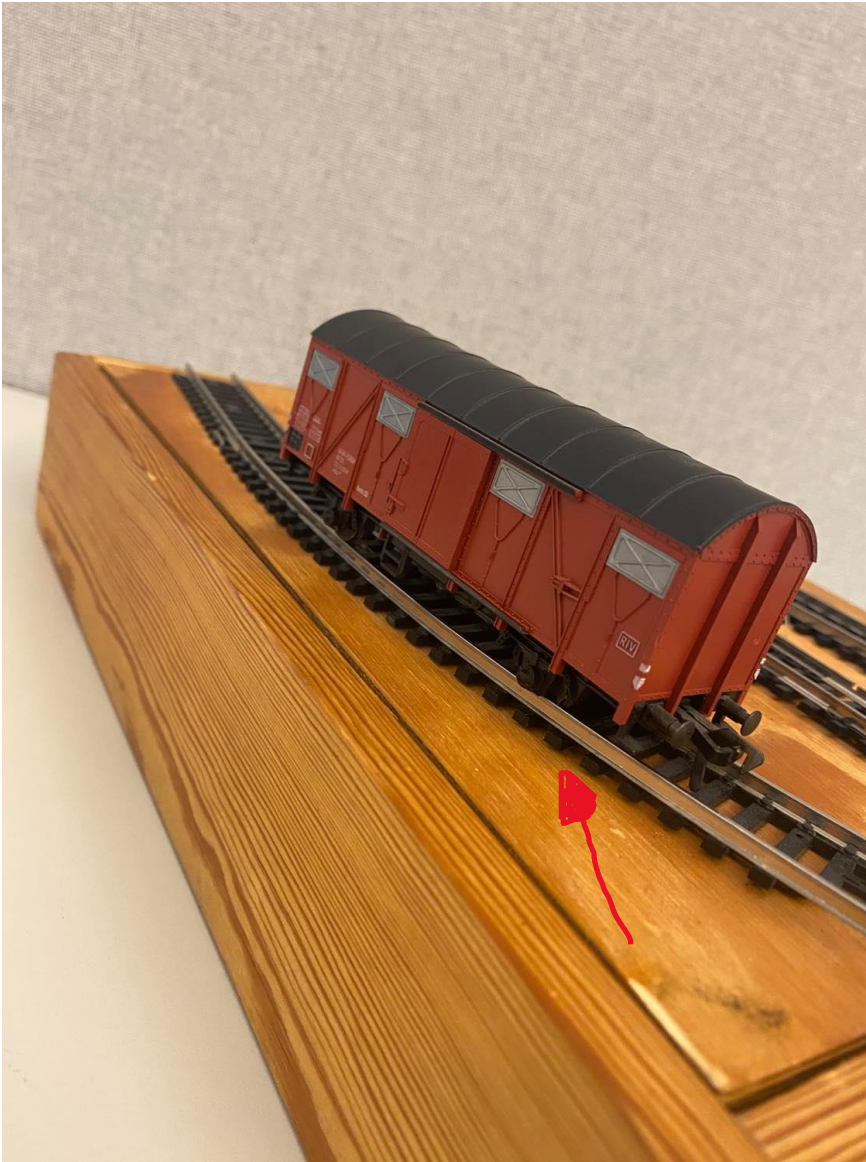
Bild 5. Bilden visar hur en bred spårvidd kan se ut. På bilden ser man tydligt hur hjulet fastnar innanför rälen och redan innan risk för urspårning kommer trång spårvidd och bred spårvidd att orsaka en ojämnt tåggång.
