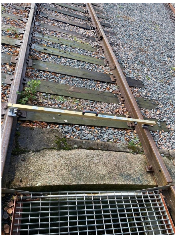
Bild 8. Bilden visar ett solapass, i bilden mäts både spårvidd samt rälsförhöjning.
