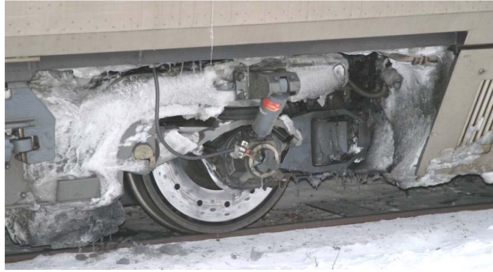
Figur 4.1.2.5.1: Snö och isbildning runt boggi / (KTH, 2011)
