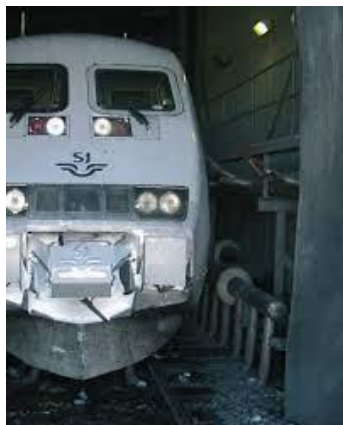
Figur 4.1.2.5.2: Avisning av ett X-2 med varmluft / (EPN Solutions, 2021)
