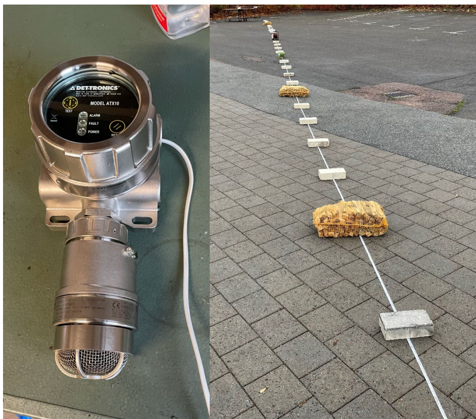
Figur 8 – Vänster: Ljuddetektorn som användes i försöken (Det-Tronics FlexSonic Acoustic Detector). Höger: Avståndsmarkeringarna som användes för att bedöma detektionsavstånden.
