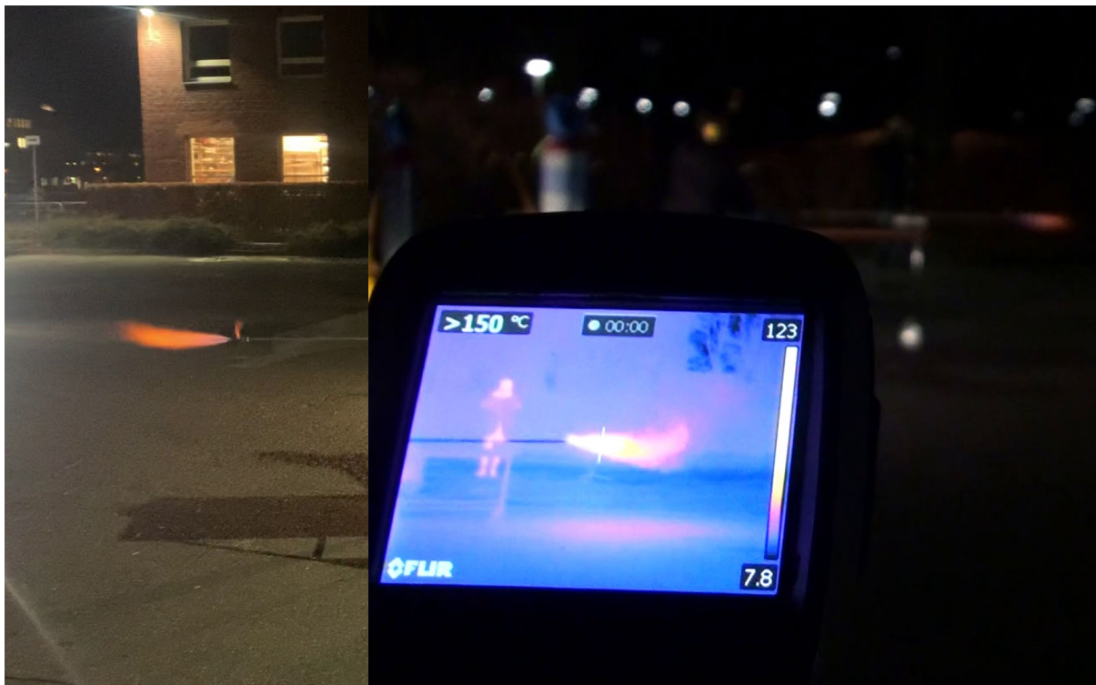
Figur 19 – Jetflamma i sent skede av utsläppet, 20 bars tryck. Vänstra delen av figuren visar hur jetflamman betraktades visuellt och högra delen visar hur jetflamman betraktades genom värmekameran.
