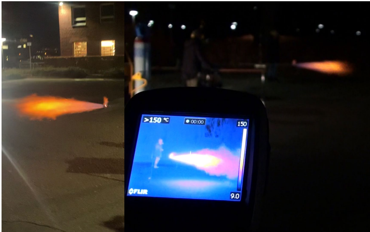
Figur 18 – Jetflamma i tidigt skede av utsläppet, 65 bars tryck. Vänstra delen av figuren visar hur jetflamman betraktades visuellt och högra delen visar hur jetflamman betraktades genom värmekameran.
