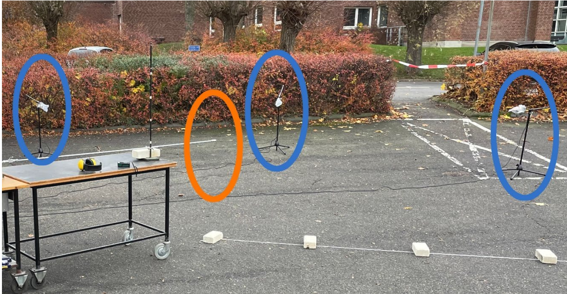
Figur 7 – Försöksuppställning. Mikrofoner markerade med blått, utsläppspunkt markerat i orange. På marken syns avståndsmarkeringar. Mikrofonerna är skyddade av plastpåsar som togs av innan försök. Mikrofonerna är från vänster placerade på 90°, 45° och 0° vinkel från utsläppet.
