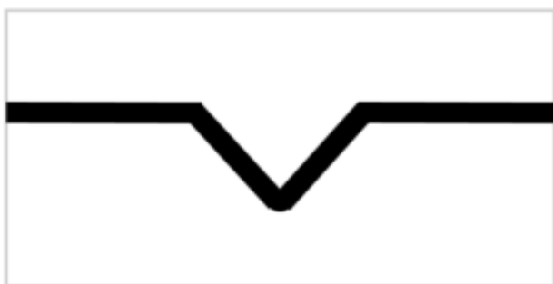
Figur 13 Schematisk bild uppifrån som visar kröken på ledstången som markerar att man befinner sig mitt för en nödutgång i Citybanan
