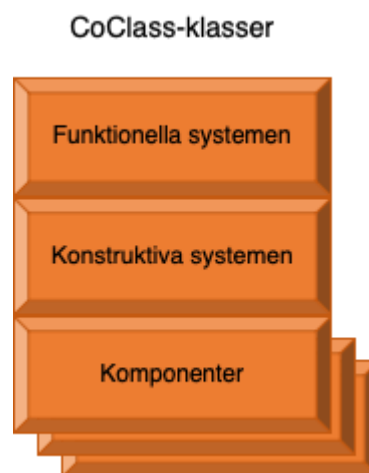
Figur 12: Överblick av CoClass hierarkiska klassifikationssystem där en komponent kan bestå av flera andra komponenter. Tolkning av figur från Framtidens smarta digitala miljöberäkning , av Erlandsson, 2017. Tillgänglig som offentlig publikation.
