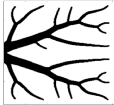
Figur 2: Resultat av optimering med begränsning av minsta radie.
