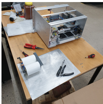
(d) Capacitors removed from the inverter.
