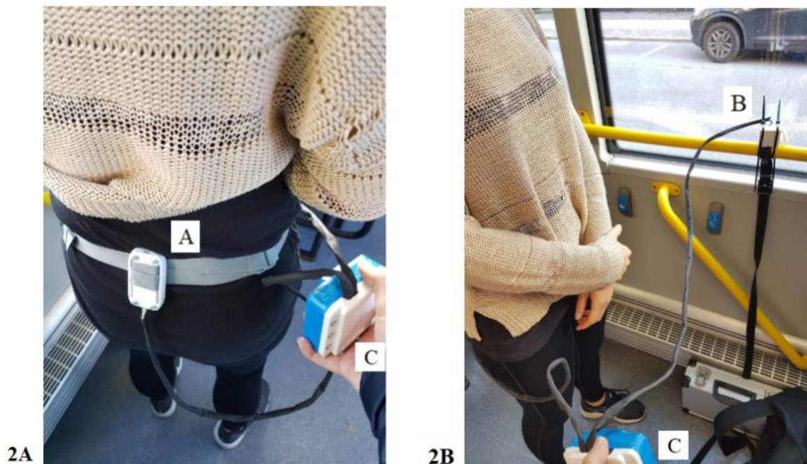
Figur 2A och B. Mätning av posturalt svaj under stående bussåkning. Kroppsburen accelerometer (A), accelerometer avsedd att mäta bussens rörelser (B) samt lagringsdosa (C).
