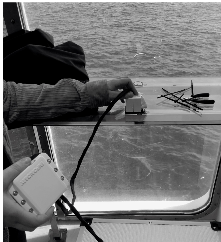
Bild 3: Referensmätningen av färjans svaj. "Näsan" visar färdriktningen.
