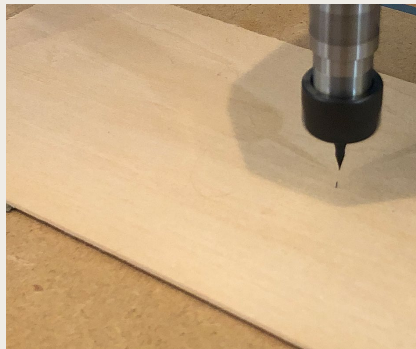
Trots det mjuka poppelträslaget gick en hel del tunna frässtål åt trots sin höga kvalitet
