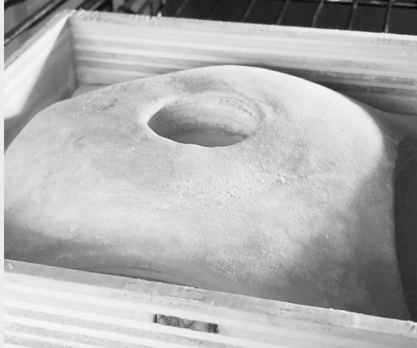
Båda delarna placerades i ugnen på grund av risk för krympning
