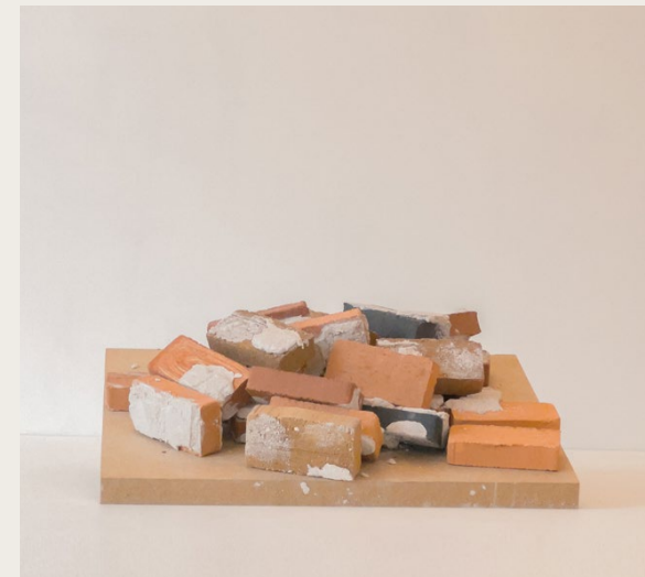
Den ena sortens murbruk passade inte för 4mm fog och skulle enligt rekommendation vara en chansning
