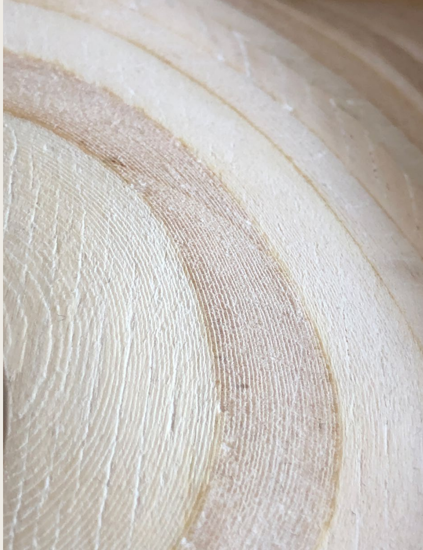
En närbild av negativet i poppelplywood, skikten ur den tredje CNC-bearbetningen kan ses väl. Detaljrikedomen blev hög
