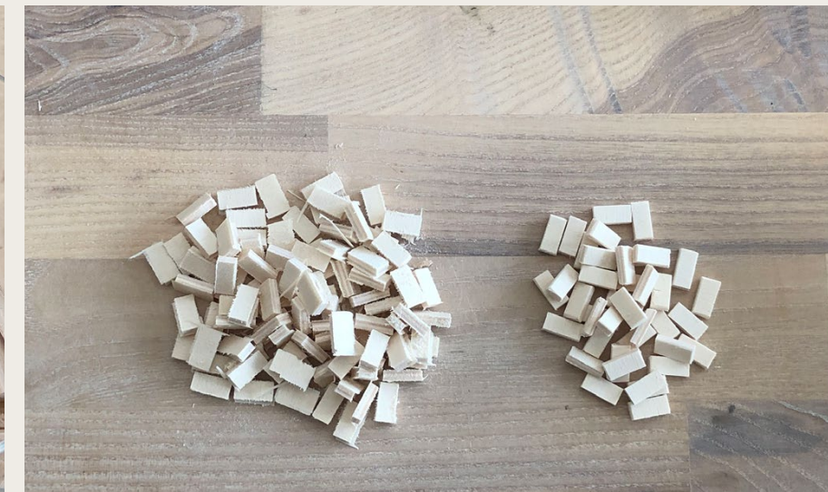
3mm poppelplywood, oslipade till vänster och slipade till höger
