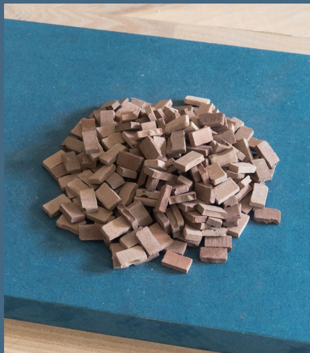
1:20 tegelstenar av betong med skiftningar av pigment
