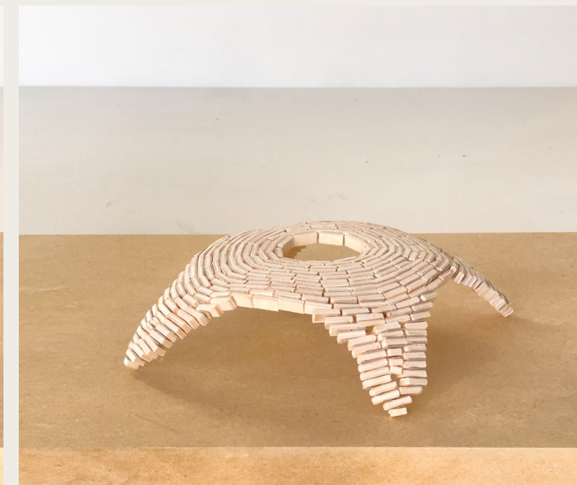
Kupolen skulle vila på hörnfundament som är illustrerade i den slutliga modellen, hållfasthetsmässigt och upplevelsemässigt vore denna kupol med fördel ingå i ett rutnät av denna komponent
