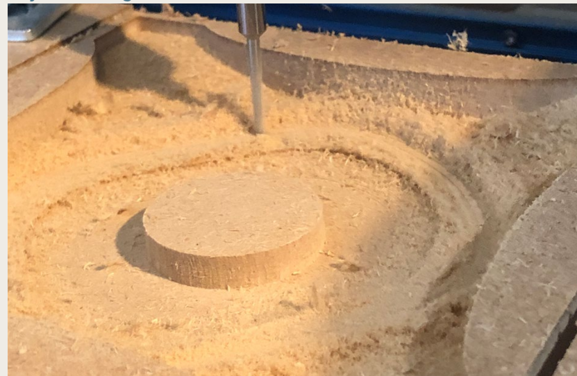
Trots det mjuka poppelträslaget gick en hel del tunna frässtål åt trots sin höga kvalitet
