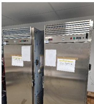
Figur 3.6. Klimatskåp för +5 och +10 °C.
