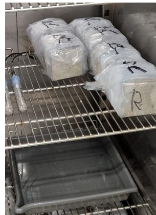
Figur 3.5. Prov förseglade med plastpåsar i klimatskåp
