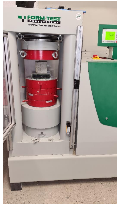
Figur 3.10. Kub i tryckpress. Observera avspjälkat material i botten av testkammaren från tidigare prov
