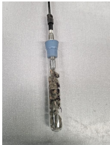
Figur 3.9. Fyllt provrör med gummipropp samt fuktgivare.
