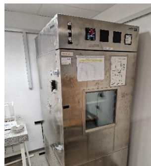
Figur 3.7. Klimatskåp för +1 °C.
