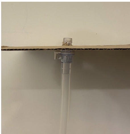
Figur 2. Prototyp 2 bestående en slang och en koppling placerad genom ett hål i en pappskiva.
