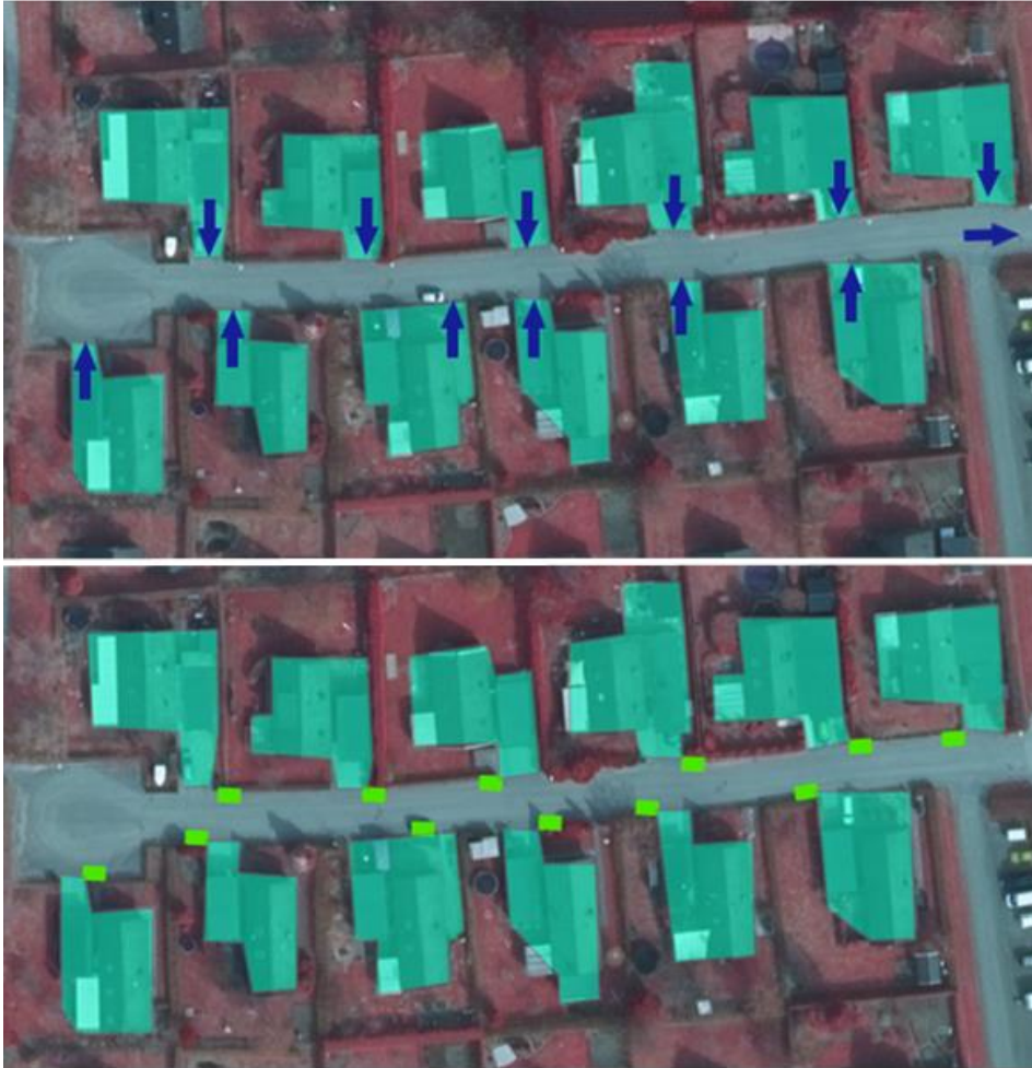
Figur 26: Den vänstra delen visar vilka fastigheter som bidrar med vatten till vägen (turkos) samt vart vattnet rinner ut (blå pil). Den högra bilden visar regnbäddarnas placering i relation till de bidragande ytorna (ljusgrönt).
