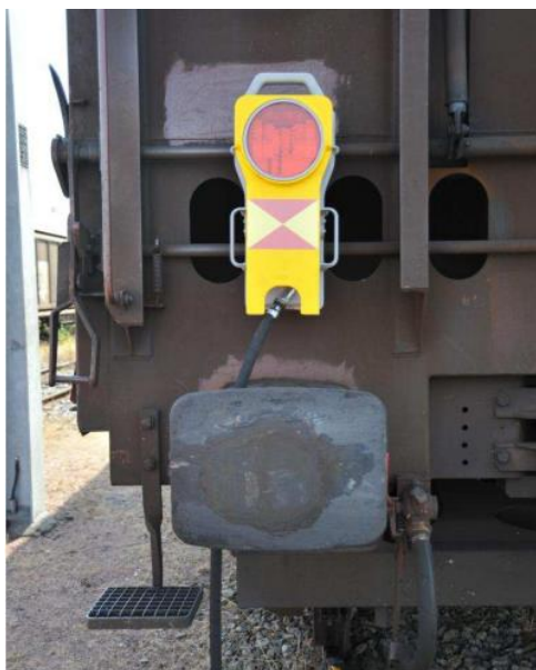
Figur 40 EOT-device monterad på godståg. Bildkälla: End of train equipment for rail freight "S-EOT", Knorr-Bremse presentationsmaterial (Knorr-Bremse, u.å).
