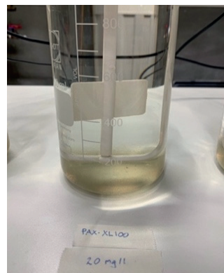
Figur 4.5. Klarfasen och sedimenteringen som kunde åstadkommas med Jar Test med dosering av 20 mg/l PAX-XL100.
