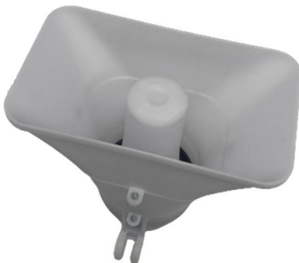
Figur 5.6. Prototyp för högtalare 1 tillverkad med MJP.
