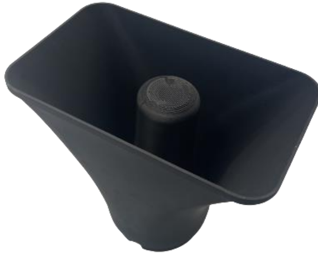
Figur 5.11. Prototyp för högtalare 1 tillverkad med FDM i PA med kolfiber.
