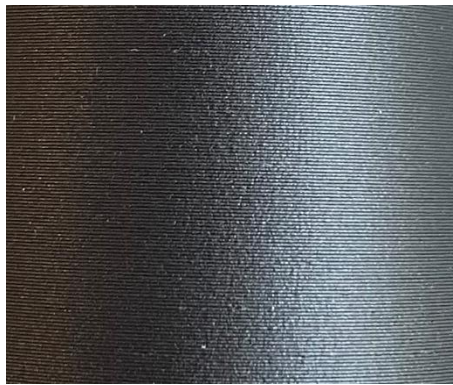
Figur 5.12. Utskriftslager med höjd 0,1 millimeter.
