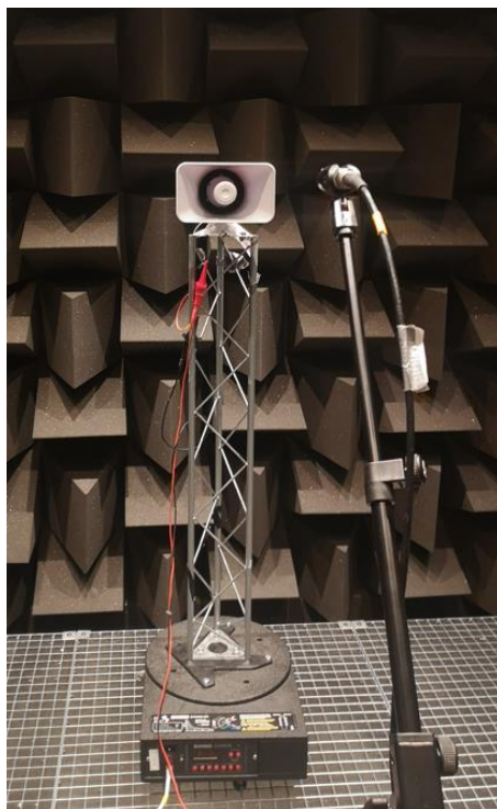
Figur 5.16. Uppställning av mikrofon och högtalare.
