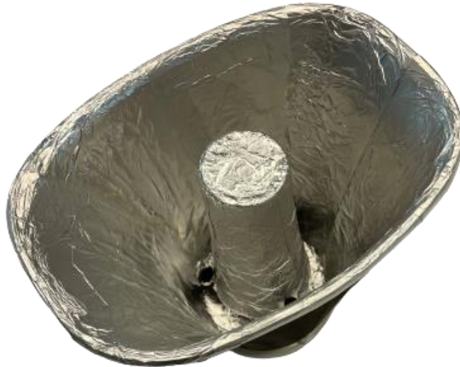
Figur 5.15. Ytbehandling med aluminiumfolie.
