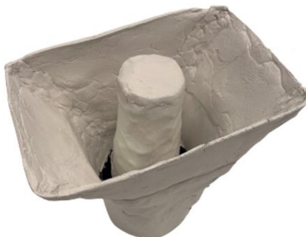
Figur 5.3. Lerprototyp av högtalare 1.
