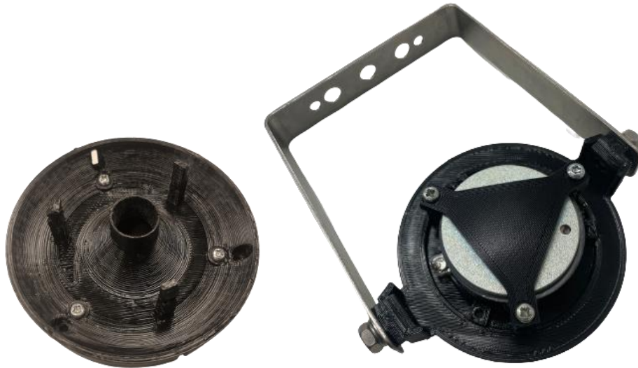
Figur 6.4. Till vänster visas fäste för högtalare 1 och till höger visas fäste för högtalare 2 tillverkat med FDM i PLA.
