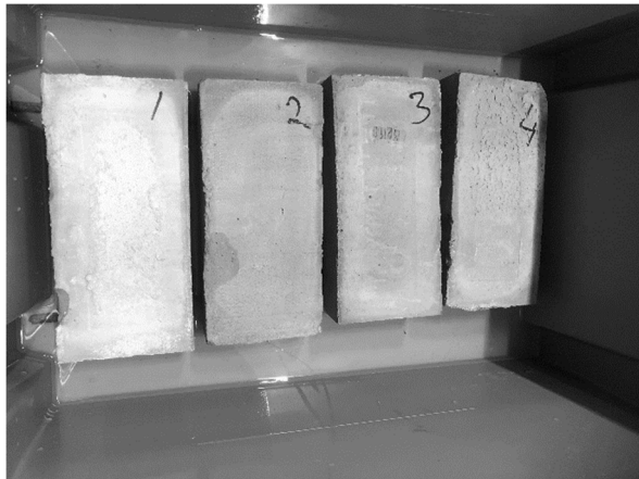
Figur 3.4 Tegelstenarna ovanpå stålstänger.
