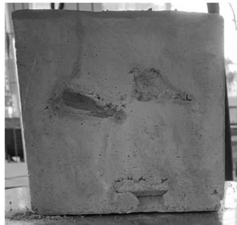
Figur 4.2 Exempel på en provkropp med acceptabel utfyllnadsgrad.
