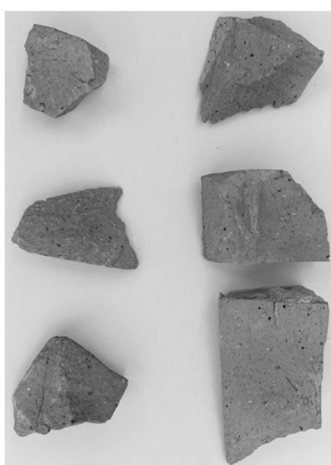
Figur 3.2 Aggregat i storlek 22,4–37 (vänster) och 37–75 (höger).
