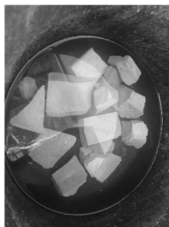
Figur 3.3 Blötläggning av tegel.
