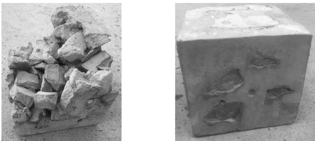
Figur 4.1 Aggregat med storleken 22,4–37 (vänster) och 37–75 (höger).
