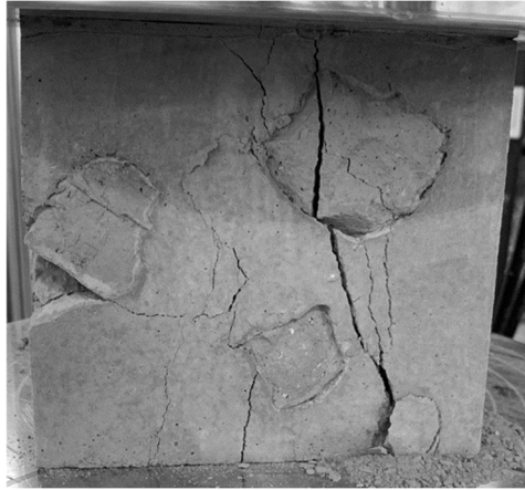
Figur 4.4 Spricka i tegelaggregat i en provkropp med 10,4 % cement.
