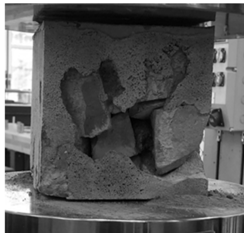
Figur 4.3 Exempel på en provkropp med oacceptabel utfyllnadsgrad.
