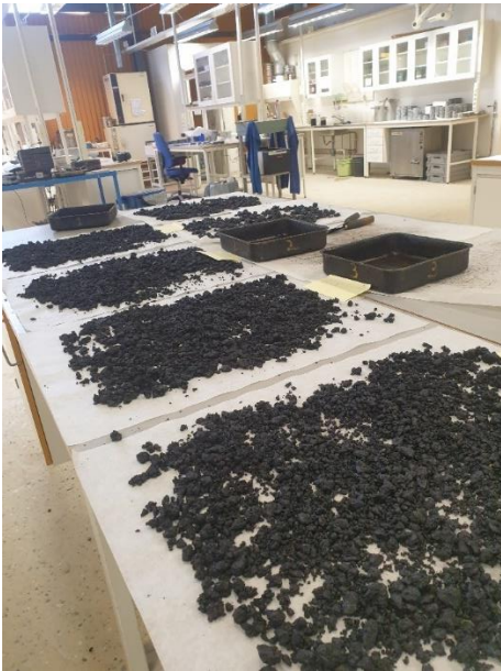
Figur 26: Uppdelning och torkning av asfaltmassa.
