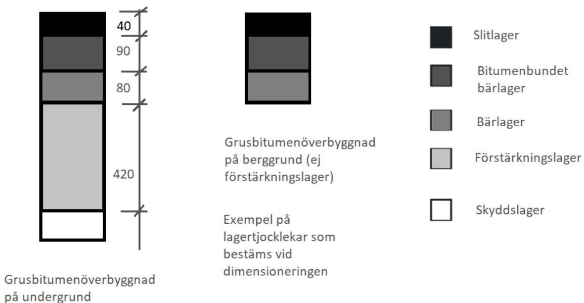
Figur 1: Typsektion av grusbitumenöverbyggnad (Trafikverket, 2021).
