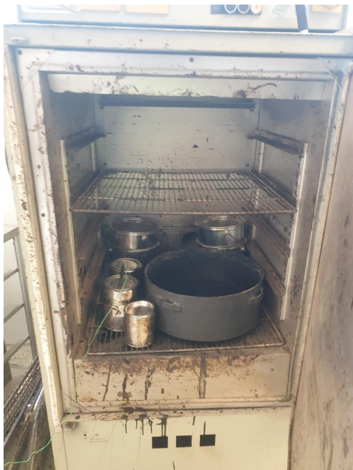
Figur 21: Värmeugn innehållande stenmaterial, tallbecksolja, bitumen och blandningskärl.
