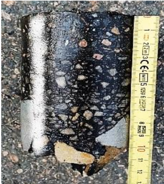
Figur 4: Fältanalys, vit spraytest på vänstra sidan av provkroppen (Sulejmani, 2022)
