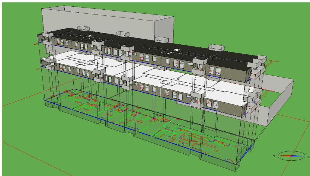
Figur 2: Uppritad 3D-modell av byggnaden i IDA av grundmodellen med omgivande byggnader. (Bildkälla: Författarna)
