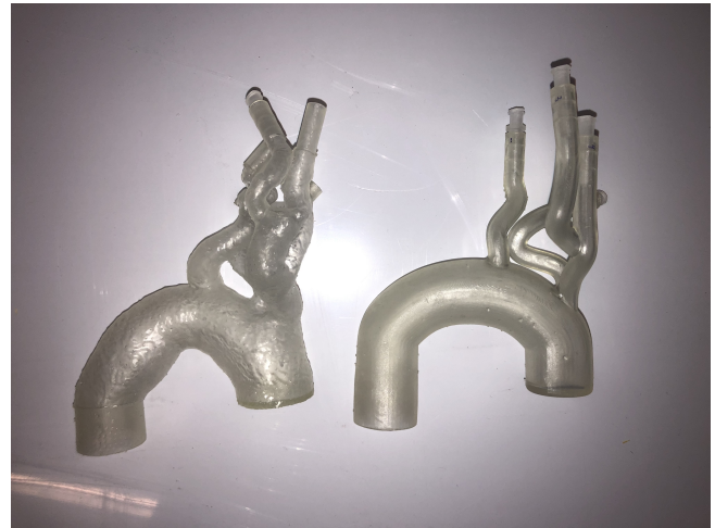
Figur 3. Figuren visar två 3D-utskrivna aortabågar. Den vänstra är segmenterad utifrån en CT-bild och den högra är formgiven i Fusion 360.
