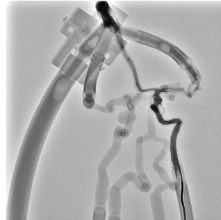
Figur 9. Figuren visar träningsmodellens intrakraniella kärl under genomlysning vid injicering av kontrastmedel i frontalplanet.
