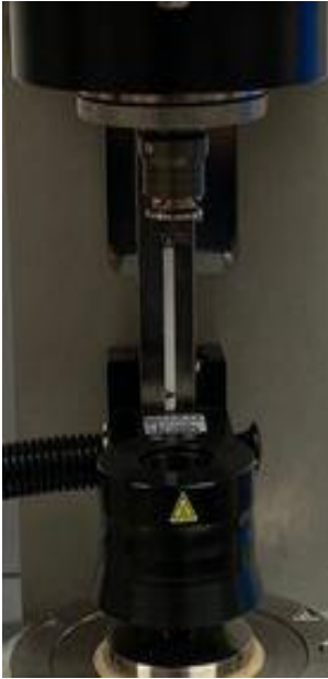
Figur 46 - värmekåpan innan den ska precis omsluter spindel och plattan.
