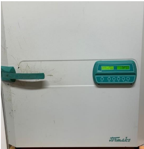
Figur 39- ugn för uppvärmning av bitumen
