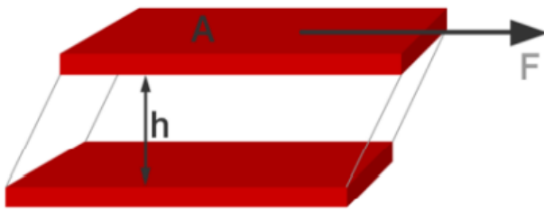
Figur 12 - Illustration av två-platt modellen (Paar, 2022b).
