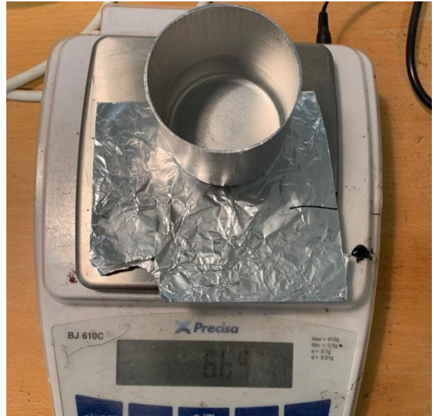
Figur 40 - Våg som används för att erhålla önskad vikt på provkropparna.
