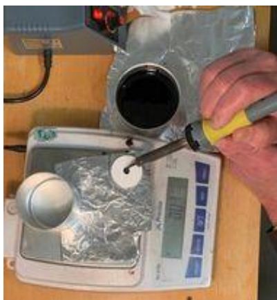
Figur 42 - Hällning av bitumen med hjälp av sked och Lödkolv.
