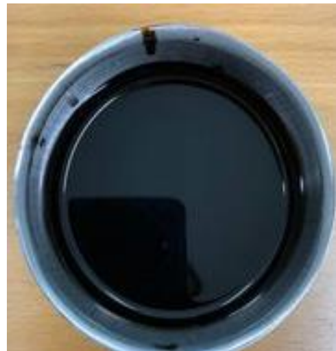
Figur 38- Aluminiumbehållare med bitumen.
