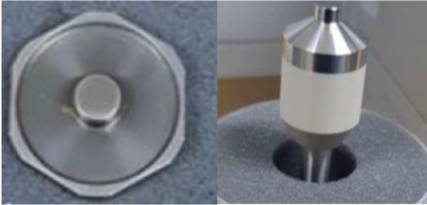
Figur 44 - Den mindre plattan och spindeln för PP08-test.
