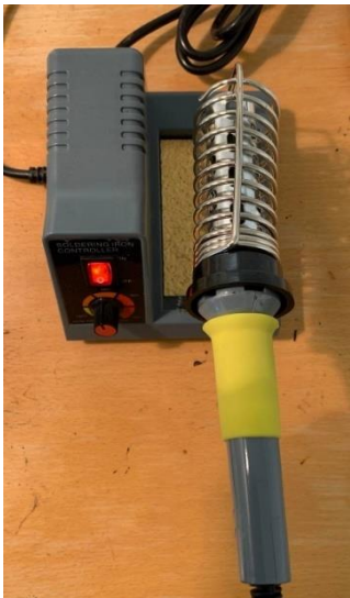
Figur 41 - Lödkolv som används för att hålla bitumen varmt vid fyllning av silikonformarna.
