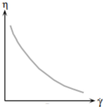
Figur 8 – Viskositetens (y-axeln) variation i takt med skjuvhastighetens (x-axeln) ändring för icke-newtonsk vätska (Brookfield Engineering, 2017).
