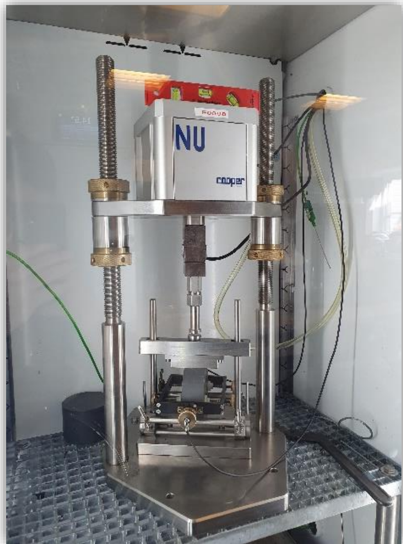
Figur 9. Uppställning av apparatur vid styvhetsprovning
