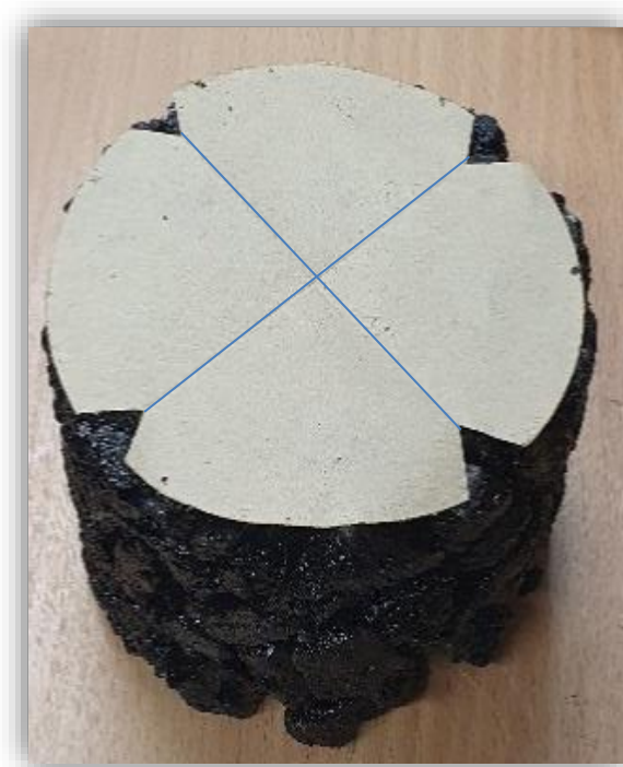
Figur 6. Mätpunkter vid dimensionsbestämning av provkropp
