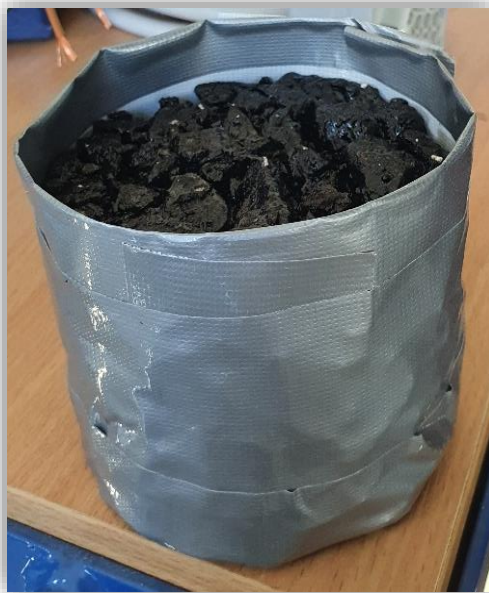
Figur 7. En asfaltprovkropp med vattentät form av silvertejp
