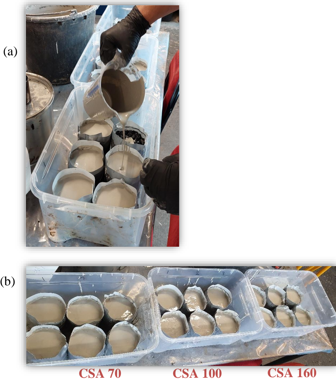
Figur 8. (a) Asfaltprovkroppar fylls med cementslamma (b) Samtliga provkroppar efter fyllnad av cementslamma
