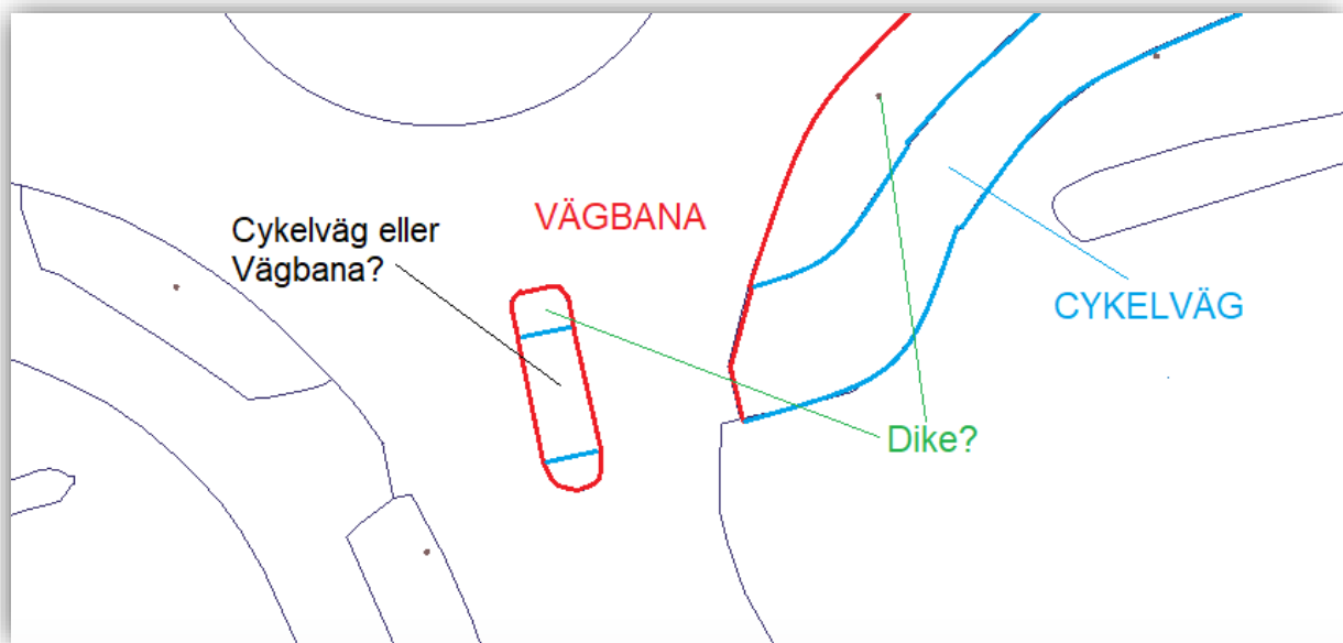
Figur 41 - Ett utdrag från Älmhults marklinjer visar hur olika kantlinjer är kategoriserade. Det krävs en spatial analys för att bestämma vilken yta som skall kategoriseras med vilken typ.
