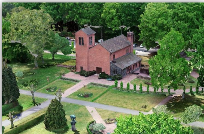
Figur 1 En fotorealistic meshmodell av Heliga korsets kapell i Ångelholm framställd genom fotogrammetri. Foto SWESCAN AB
