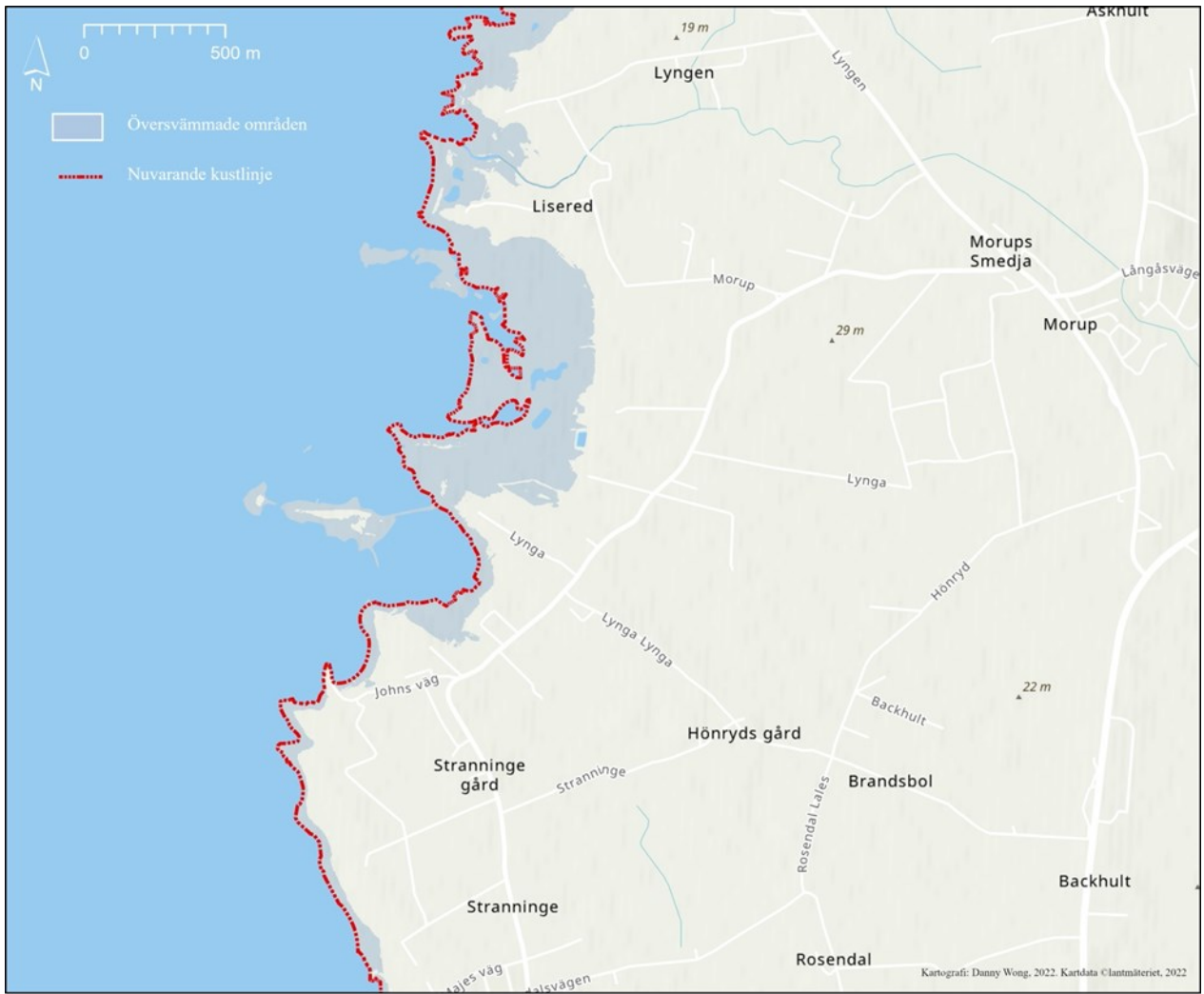
Figur 5. Översvämmade områden under en simulerad stormflod med en vattenståndsnivå på 147 m. Påverkade markområden är markerade med ljusblå färg. Berörda området är beläget i Morupstrakten, Halland.
