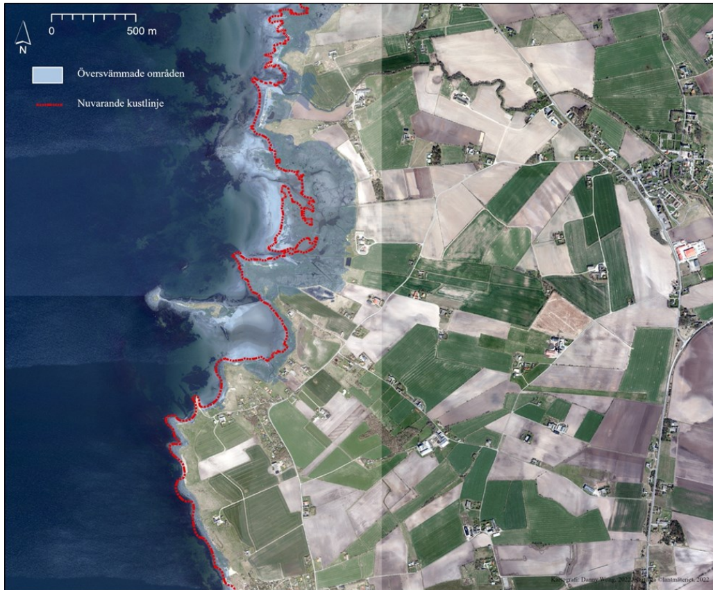
Figur 6. Ortofoto som visar översvämmade områden under en simulerad stormflod med vattenståndsnivå på 147 cm. Påverkade markområden är markerade med färgindikation. Berörda området är beläget i Morups trakten, Halland.
