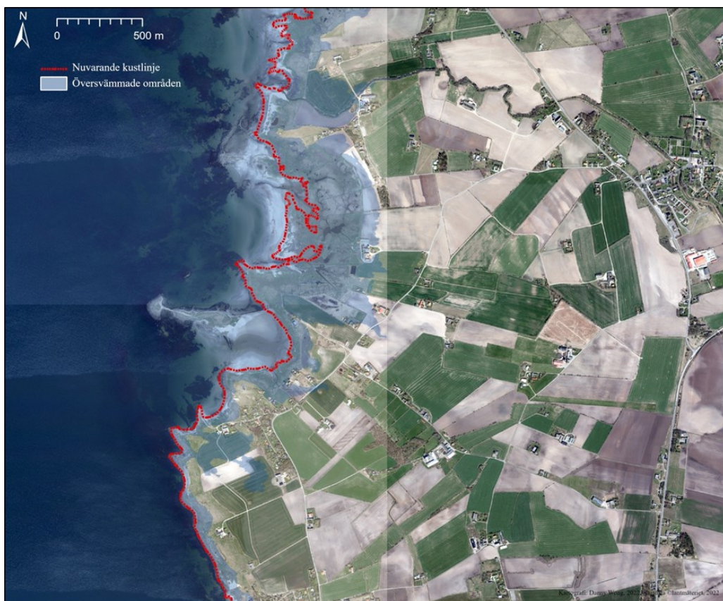
Figur 7. Ortofoto som visar översvämmade områden under en stormflod med ett högsta vattenstånd på 147 cm plus det estimerade framtida vattenståndet på 116 cm. Kartan är således simulerad efter ett vattenstånd på 263cm. Påverkade markområden är markerade med färgindikation. Berörda området är beläget i Morups trakten, Halland.
