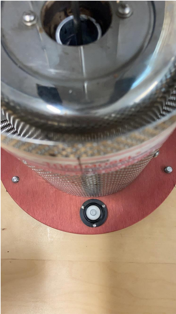
Figur 13 Vattenpass på thermoselen
