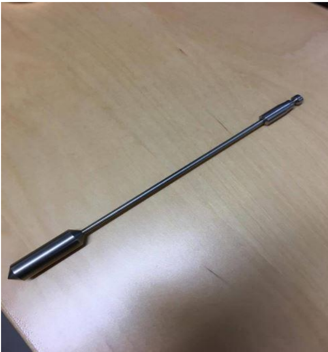
Figur 6 Spindeltyp SC4-27 som användes i maskinen
