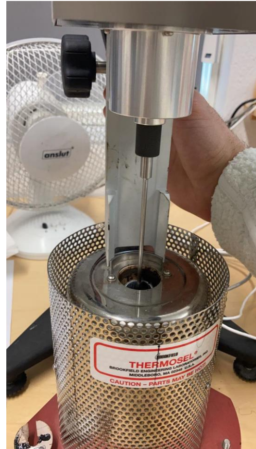
Figur 12 Nedsänkning med hjälp av spaken
