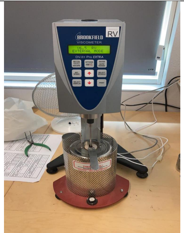
Figur 8 Utrustning för Brookfields rotationsviskosimeter, RVB
