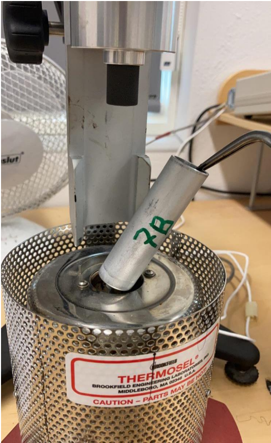
Figur 9 Provrör förs in i provrörsbehållare
