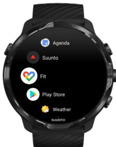
Figur 1: Visar hur en huvudmeny kan se ut på Wear OS. Notera sidknapparna som kan agera som antingen bakåt- eller hemknapp.
