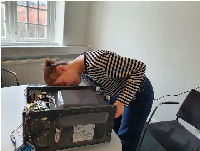
Figur 1. Figuren visar när Tove placerar IR-sensorn igenom ett av mikrovågsugns ventilationshål
