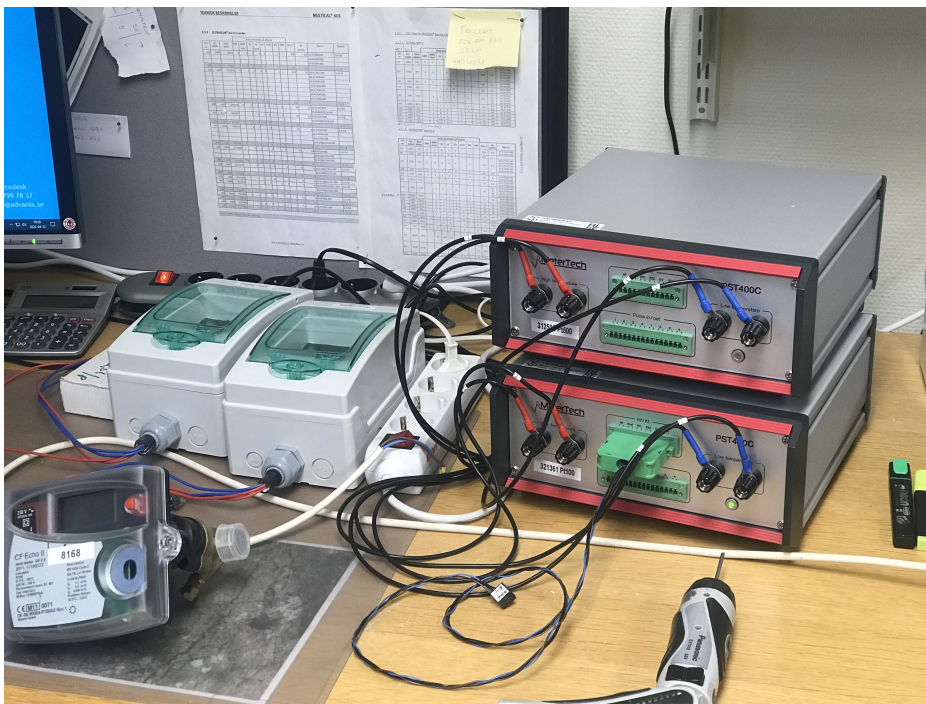
Figur 2.18: Två elektriska motstånd används för integreringsverk kalibrering
