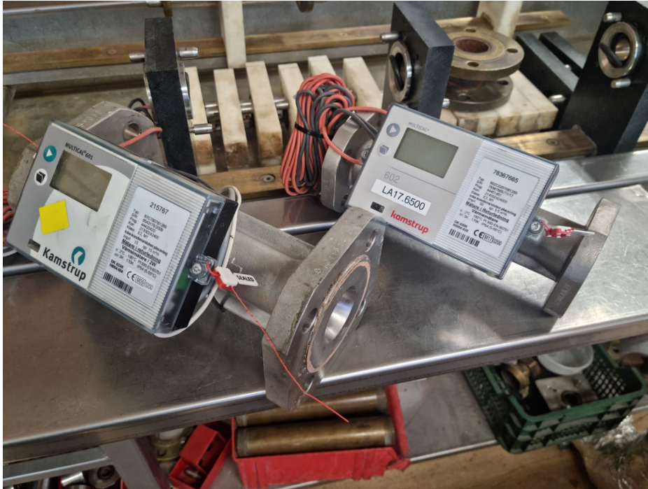
Figur 2.12: Två flödesmätare med två olika storlekar tillsammans med integreringsverket och temperaturgivare.
