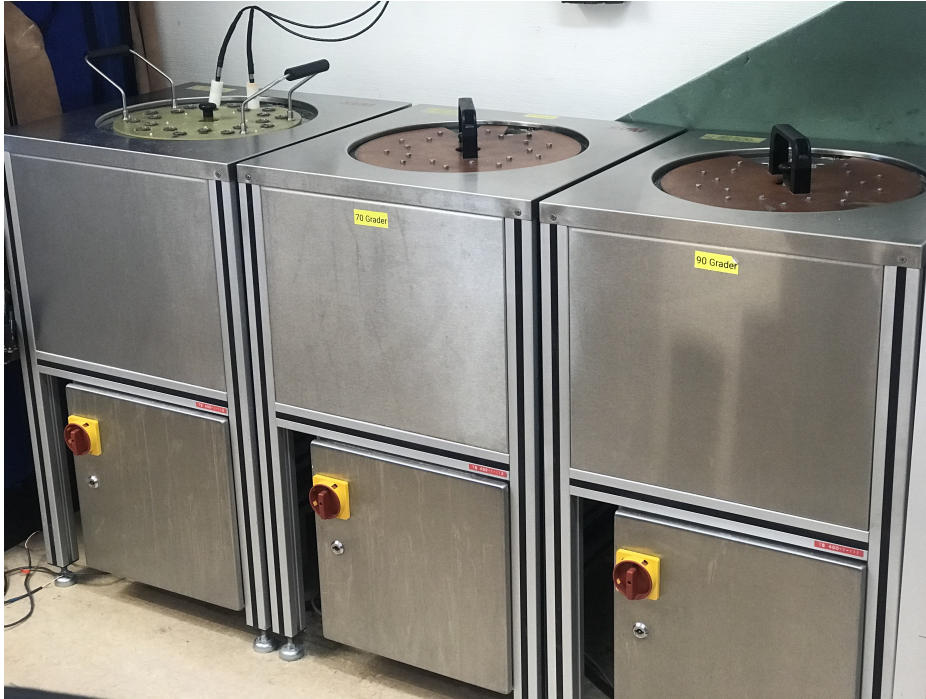
Figur 2.17: Vattenbad med tre olika temperaturer: 40, 70 och 90°C.
