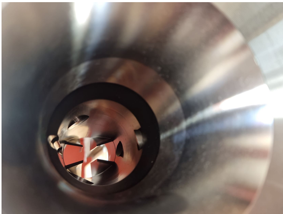
Figur 2.11: Ultraljud flödesmätare rör med ultraljudsspeglar in i rör.
