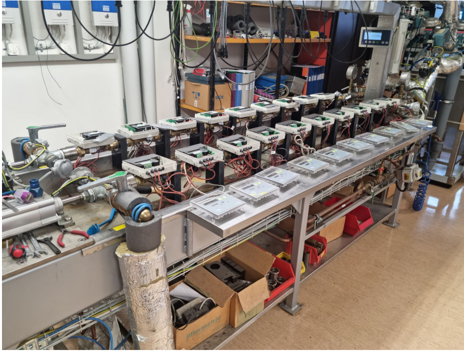
Figur 2.16: Kontrollanläggning i kontroll laboratorium för kalibrering av flödesgivare.
