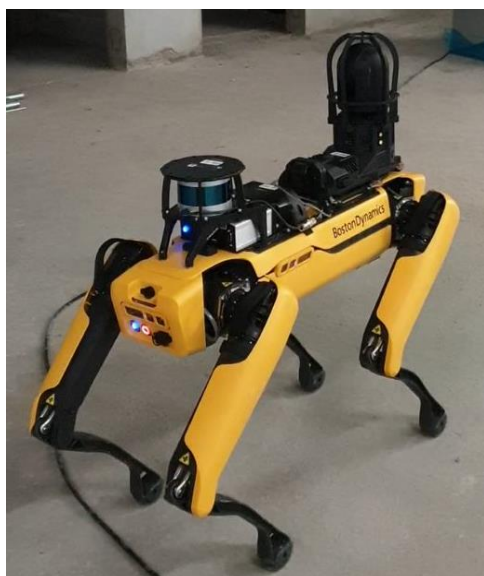
Figur 2: Spot med LiDAR-pucken monterad.
