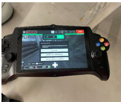
Figur 22: Plattan som används för att styra roboten och en överblick av hur det såg ut när felmeddelandet dök upp.
