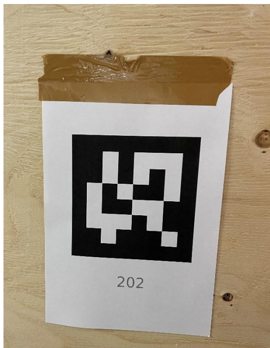
Figur 4: En fiducial, som används när ett mission för Spot ska initieras.
