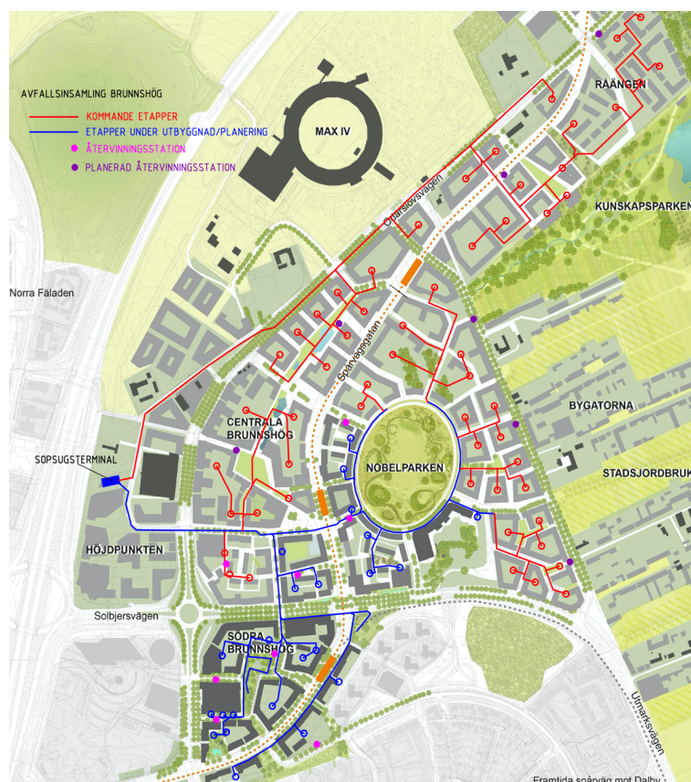
Figur 1. Översiktsritning över sopsugssystemet i Brunnsjön med antalet inkastpunkter samt dess ungefärliga placering utplacerade (Lunds kommun, 2021a). Publicerad med tillstånd av Lunds kommun.
