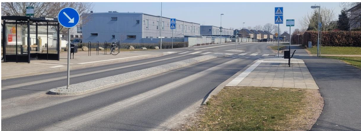
Figur 16: Egentagen bild som visar mittrefugan som hindrar omkörning av buss (2022).
