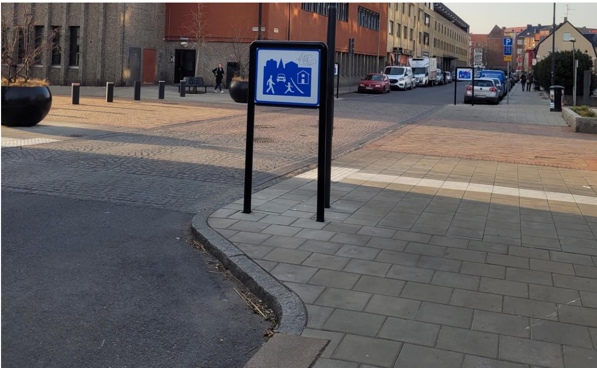
Figur 12: Egentagen bild som visar klacken, den upphöjda korsningen samt skyltning om gångfartsområde. Den tydliggör även att den södra delen av Nedre Nytorgsgatan har stängts av för motorfordon som saknar behörighet (2022).
